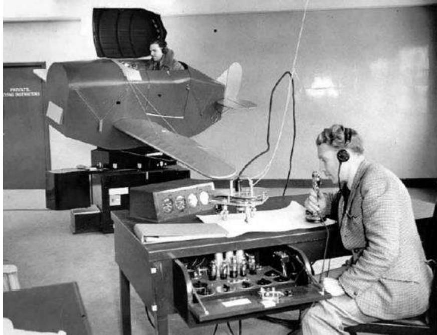
Figura 1-2 Link trainer simulador de vuelo que permitía a los pilotos practicar en vuelo, los instructores podían evaluar las habilidades de vuelo, se simulaba el entorno de la cabina, su comportamiento dinámico y el rendimiento de forma neumática. Allerton D. (2009)
