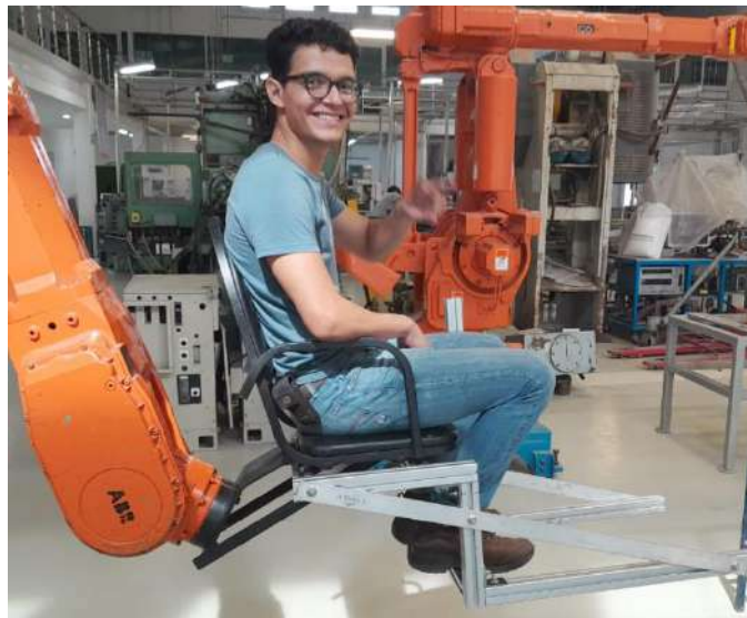
Figura 3-21 Se realizaron movimientos bruscos encima de la silla, se probó la resistencia que tienen los perfiles donde reposan los pedales y se aplicó una fuerza en el extremo de manera exagerada
