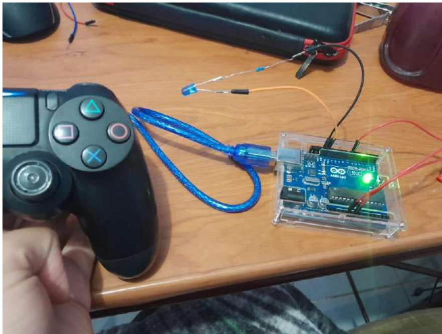
Figura 4-11 Circuito utilizando un controlador Arduino UNO , para enviar señales de voltaje al controlador del robot, se utilizaron 3 relevadores y 3 resistencias de 1000 ohms
