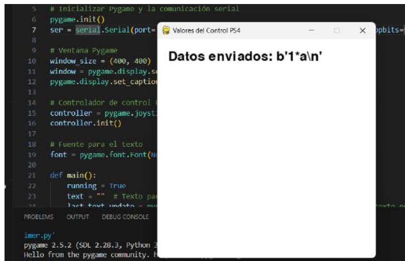
Figura 4-9 Este programa se encuentra en el anexo 13, lo que se muestra en la imagen es la ventana resultante de dicho programa, donde se representa lo que se está enviando al robot de forma serial por medio del lenguaje de programación Python.
