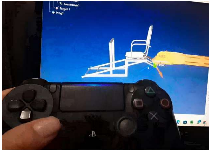
Figura 4-4 Movimiento del robot virtual guiado por medio del control de PS4
