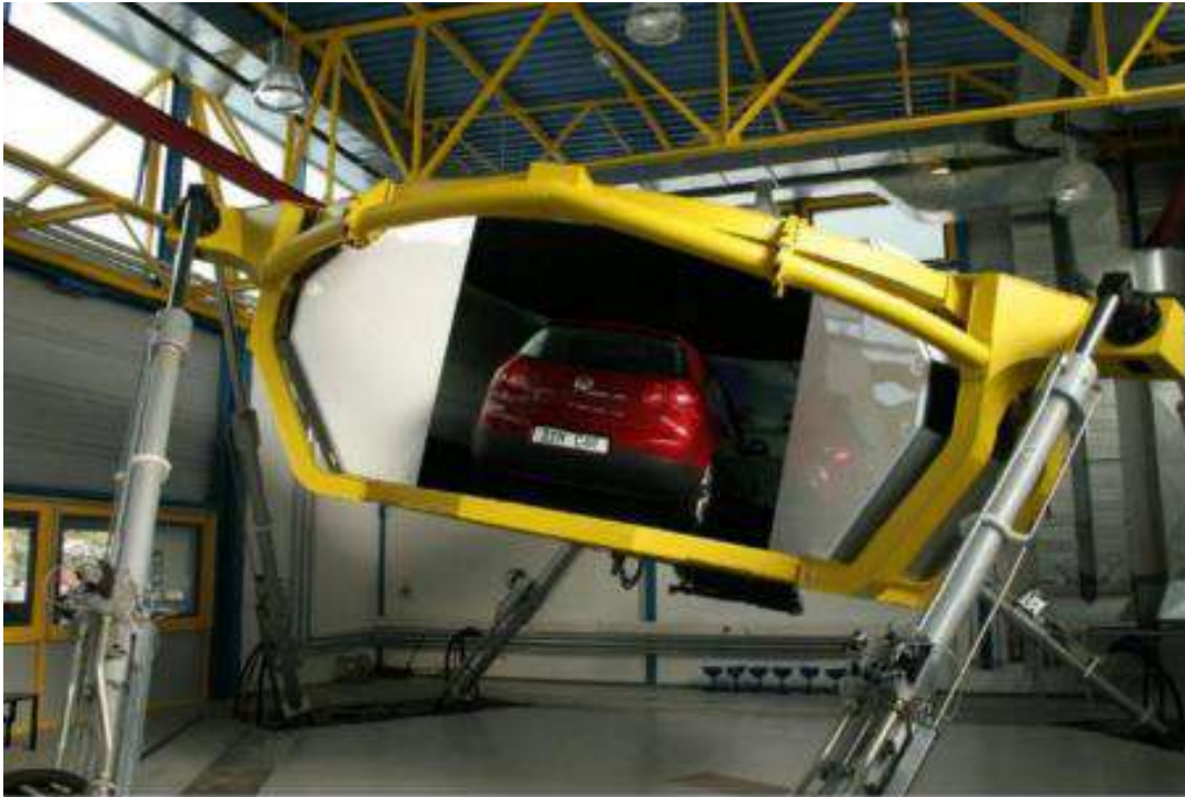
Figura 1-3 Simulador de conducción que utiliza una plataforma Stewart para recrear los movimientos de un automóvil. Suikat, R (2005)
