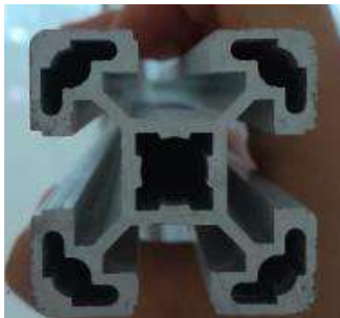
Figura 3-7 Perfil estructural de aluminio Bosh de 40mm x 40mm
