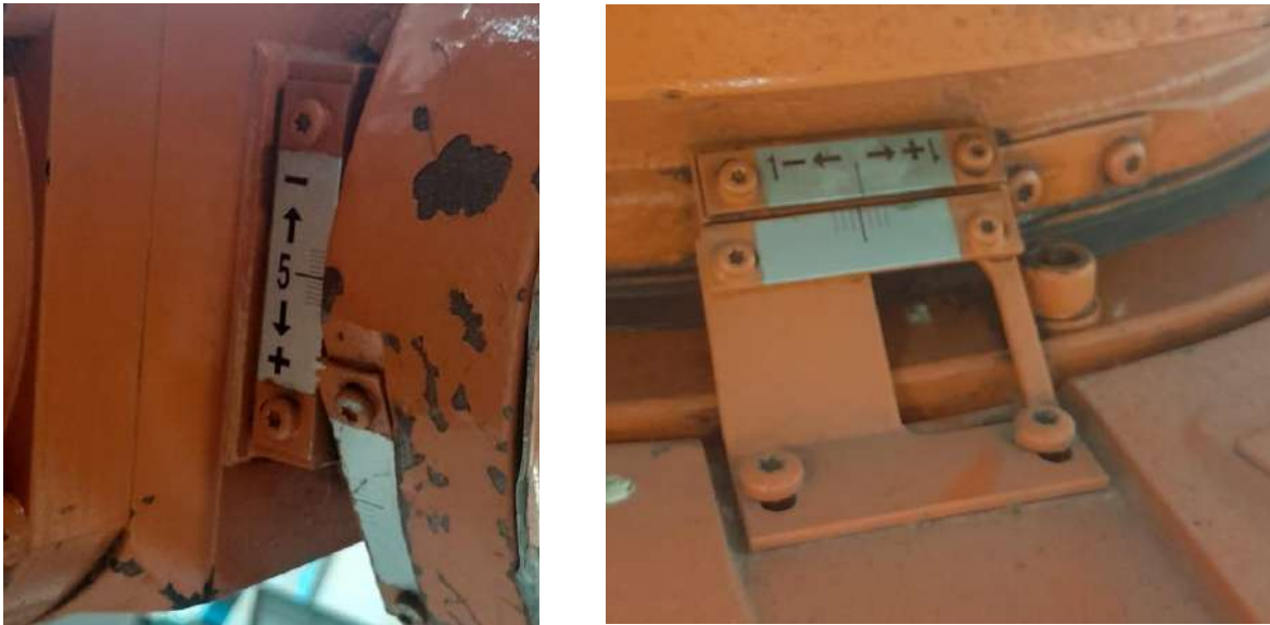
Figura 3-2 Calibración del eje 5 y 1, se llevan las líneas más gruesas a tocarse entre sí, eso indicaría el cero
