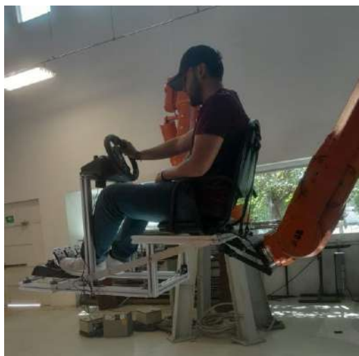
Figura 3-20 Se comprueban los movimientos en todas las direcciones, así como el funcionamiento de cambio de ejes evaluando cualitativamente la vibración debida al cambio rápido de movimientos
