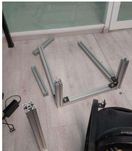
Figura 3-16 Conexión de los perfiles estructurales de aluminio
