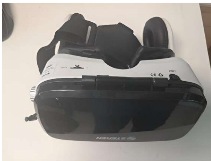
Figura 2-7 Lentes de realidad virtual, los cuales solo se le puede adaptar al visor una pantalla de teléfono celular
