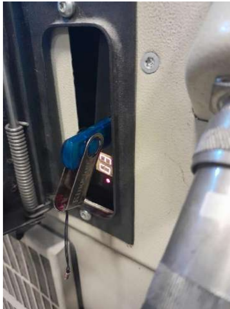
Figura 4-17 Carga al controlador de un programa que reciba los datos que se mandan de Python , mediante una USB
