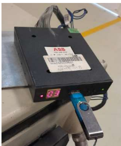
Figura A1-8 Convertidor de disquetes, alimentar las configuraciones de cada robot ABB
