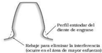
FIGURA 7.20 Diente rebajado de un engrane.
