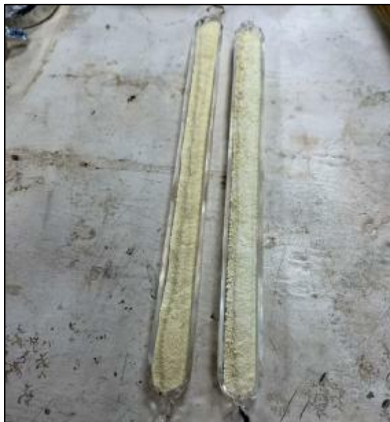
Figura 2.8. Muestras en las canoas de cuarzo.
