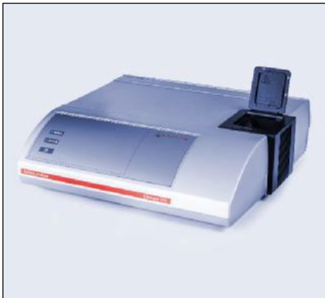
Figura 2.17. Analizador del tamaño de partícula.
