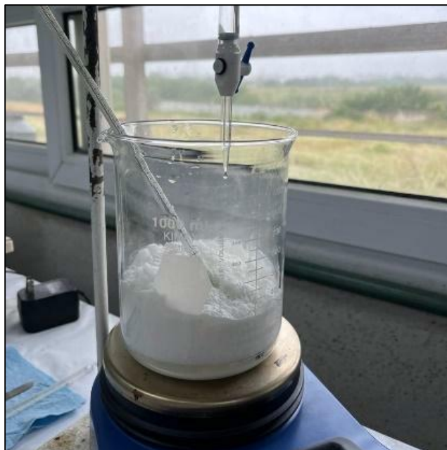
Figura 2.3. Proceso de síntesis de la HAp.
