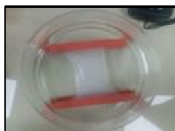
Figura 2.5 Nanocelulosa sometida a diálisis.
