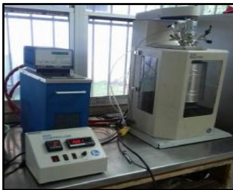
Figura 2.17 Reactor PARR tipo batch modelo 5100.
