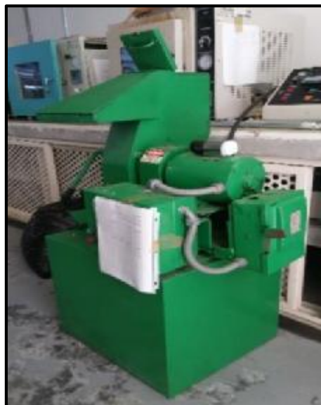
Figura 2.3 Triturador modelo 2031-SP de IMS Company.
