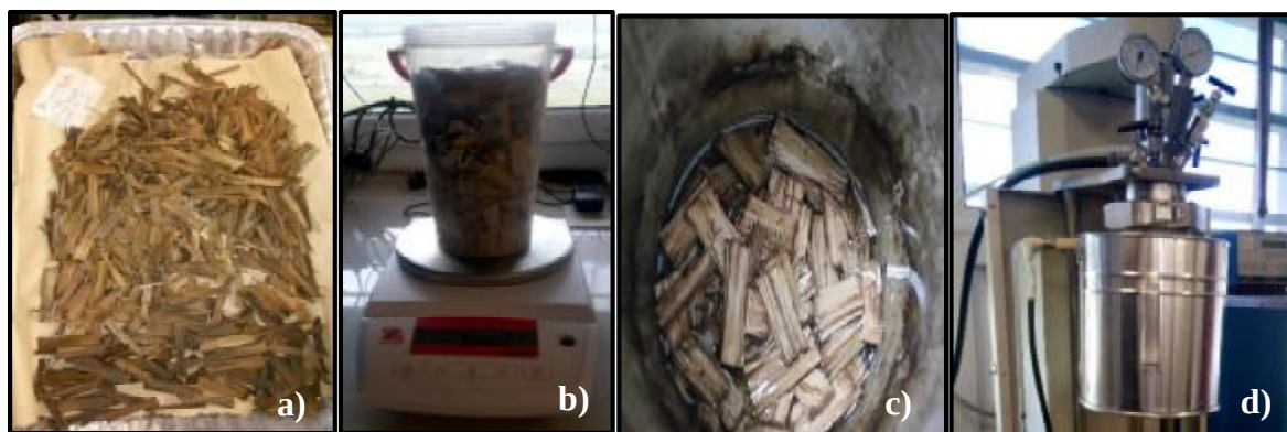
Figura 2.18 Esquema visual del proceso de hidrólisis ácida de la fase sólida del tule.
