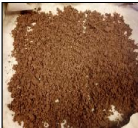
Figura 2.14 Secado de la fase sólida obtenida de la autohidrólisis de tule.
