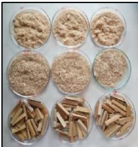
Figura 2.6 Determinación de porcentaje de humedad de la materia prima utilizada.
