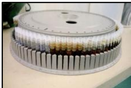
Figura 2.21 Muestras en viales colocadas en el carrusel del HPLC Waters.
