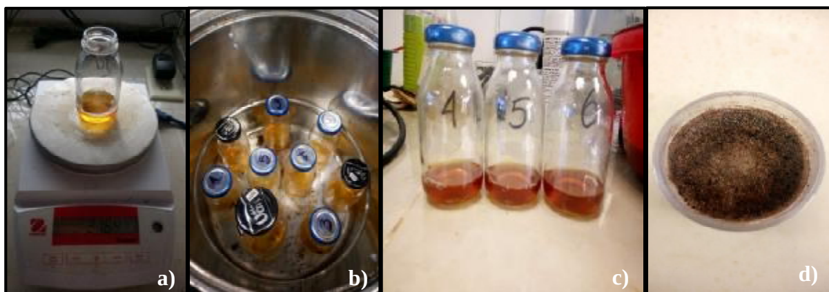
Figura 2.16 Esquema visual del proceso de hidrólisis ácida de la fase líquida.
