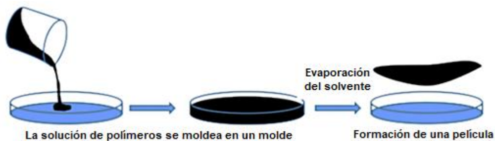
Figura 1.6 Esquema del método convencional Casting
