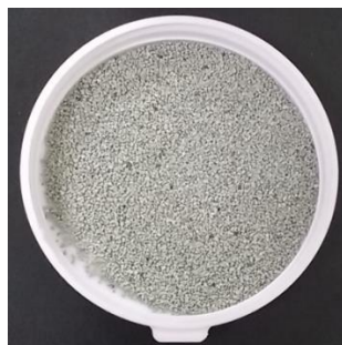
Figura 3.1 Zeolita de Oaxaca después del acondicionamiento con NaCl.
