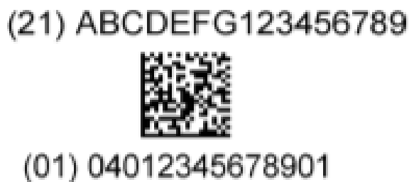
Figura 15. Símbolo GS1 Datamatrix (AI 21)
