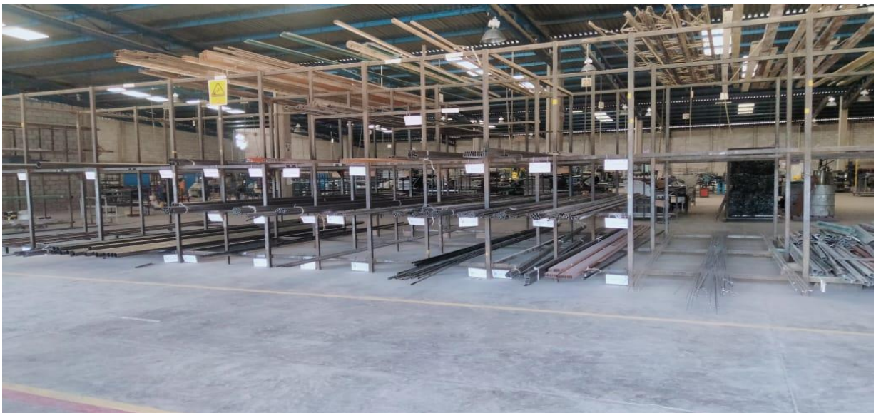
Figura 11. Anaquel después de la mejora. en esta imagen se logra apreciar la mejora implementada en la sección de anaquel, distribuyendo los tubos, después de la mejora se logró reducir tiempos.
