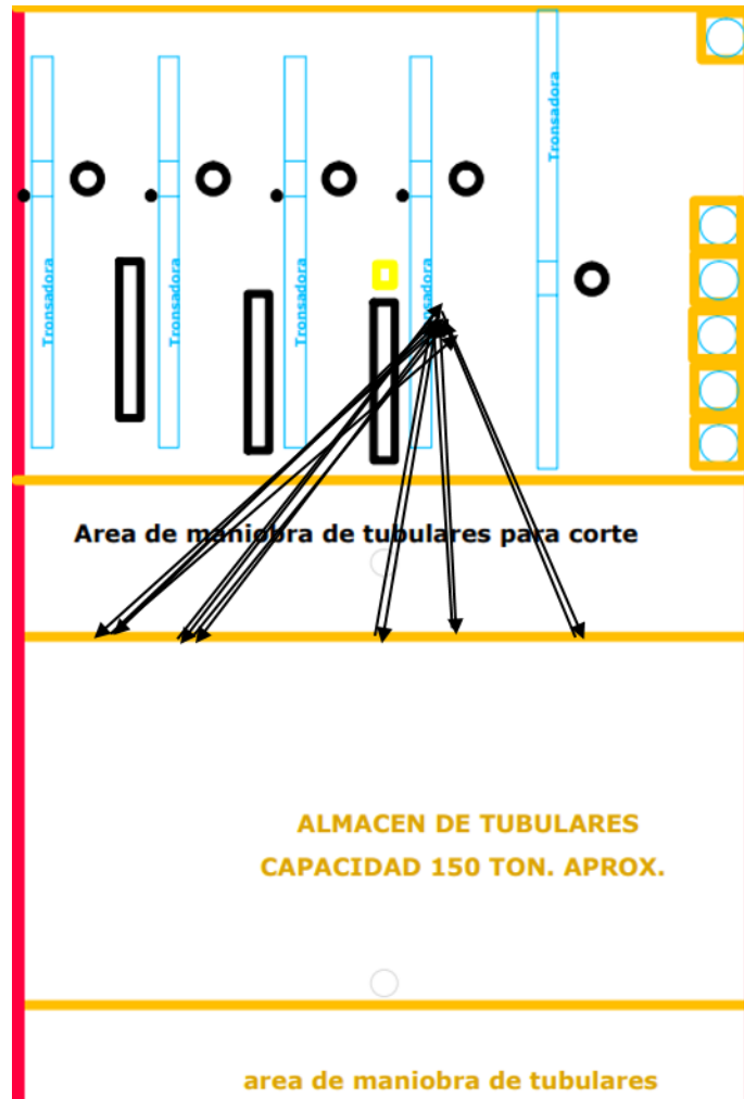
Figura 6. Diagrama de hilo de los ciclos empleados por un operador para desarrollar el corte de un producto, esto con relación a la máquina de corte número 2
