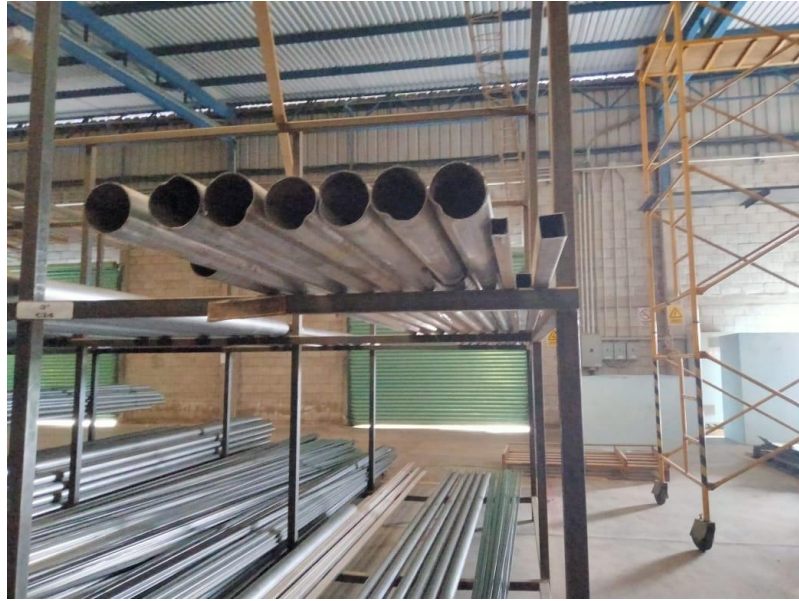
Figura 9. Casillas de tubos del anaquel. Aquí se muestra que una misma casilla contiene distintos tipos y medidas de tubos, lo cual ocasiona un retraso en cada ciclo para ir por materia prima.
