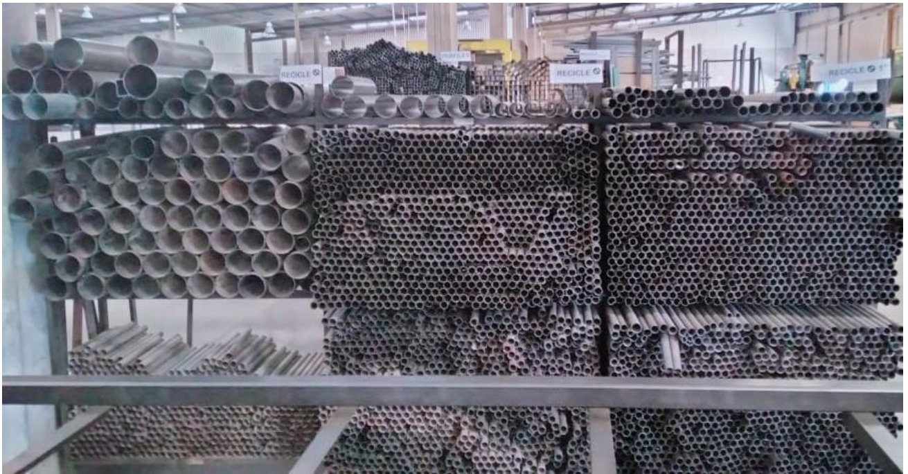
Figura 13. Anaquel lateral de tubo ya reacomodado de acuerdo al nivel de producci3n y a frecuencia en que se utiliza.
