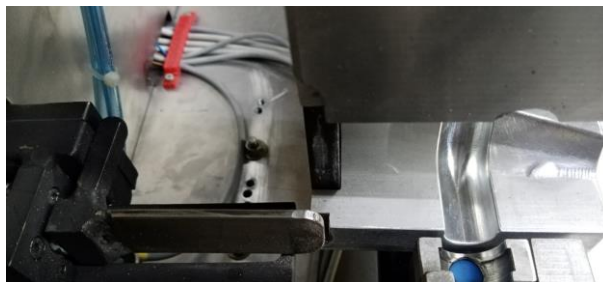
Figura 28 Después de mejora (cavidad para evitar choque con fixtura)
