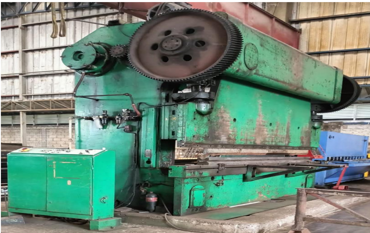
FIGURA 8 Dobladora (se realizan dobleces de placa menor a 1/4" y laminas)
