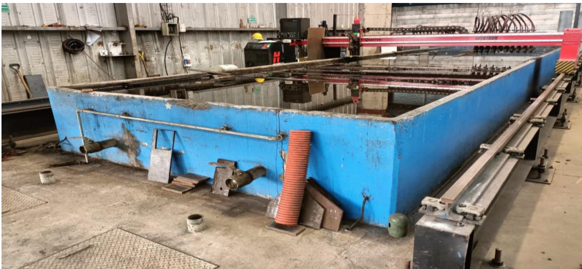
FIGURA 7 Plasma 2 (se corta placa menor de 1 1/2" de espesor)
