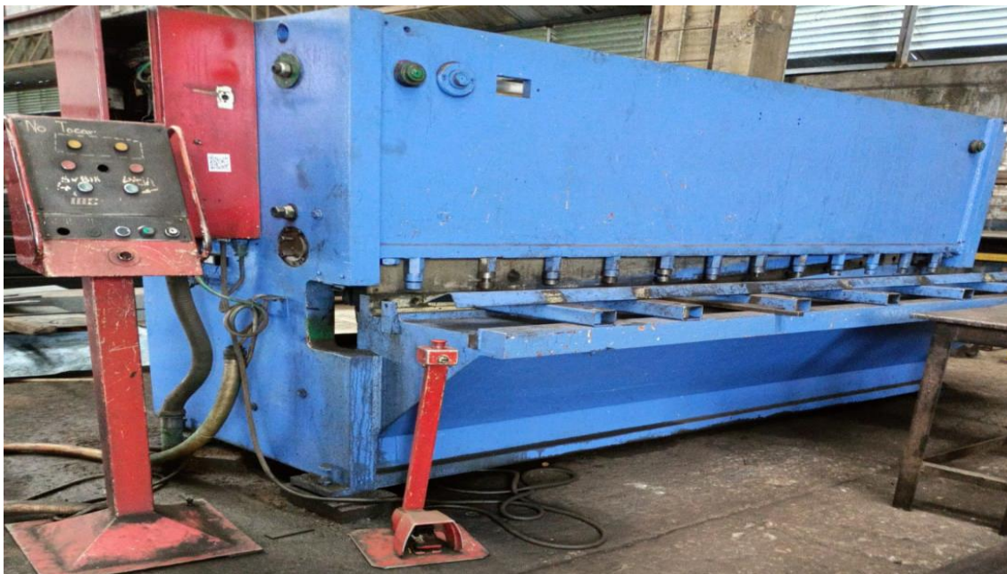
FIGURA 9 Cizalla (corta lamina y placa menor de ¼")
