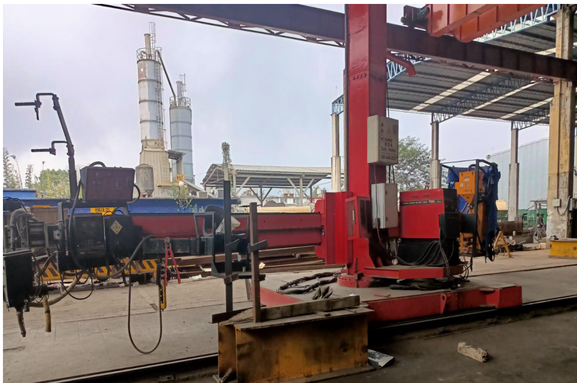
FIGURA 10 Arco sumergido (soldadura de columnas en cajón o tubería de dimensiones grandes)
