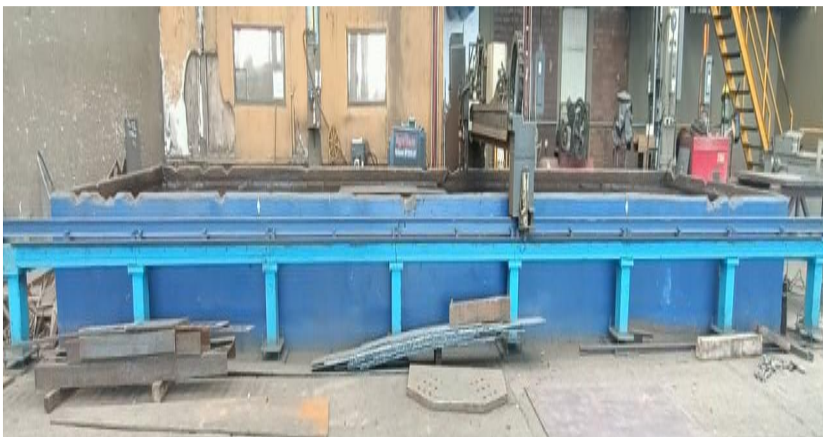
FIGURA 6 Plasma 1 (se corta placa menor de 1.5 " de espesor)
