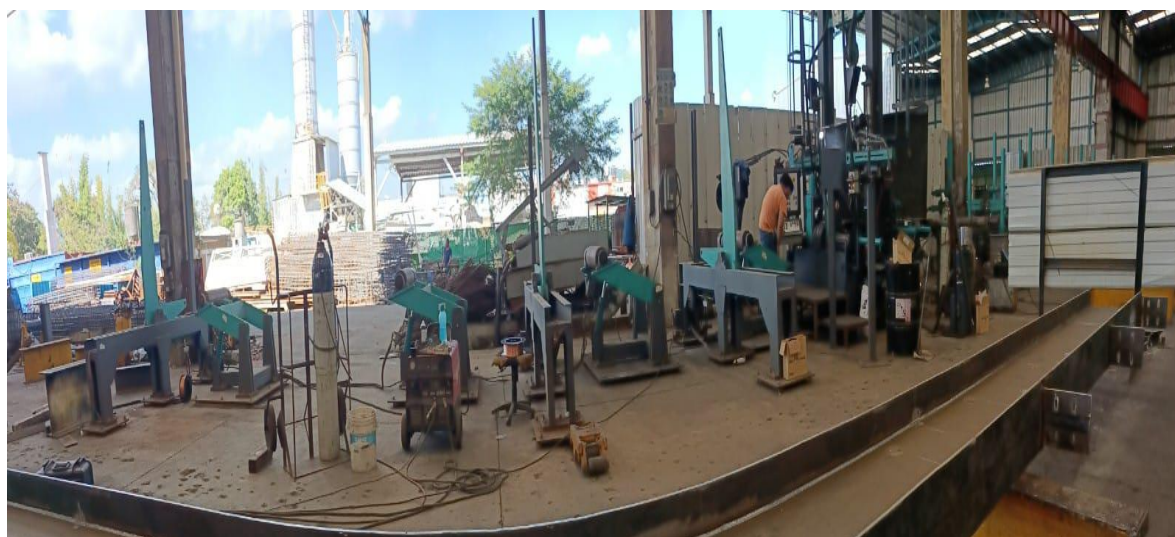
FIGURA 11 Armadora de vigas (soldadura de vigas)
