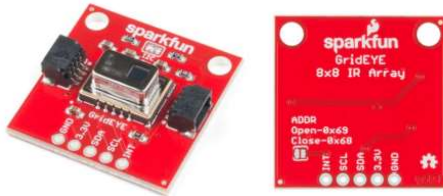
Figura 1 Sensor de detección de calor (Grid-EYE)
