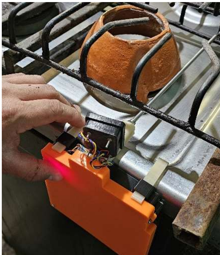
Figura 81 Colocación del modelo en la estufa con hornilla de barro
