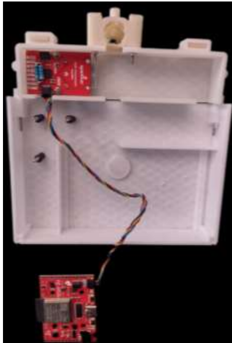
Figura 43 Amplificador y Datalogger conectados
