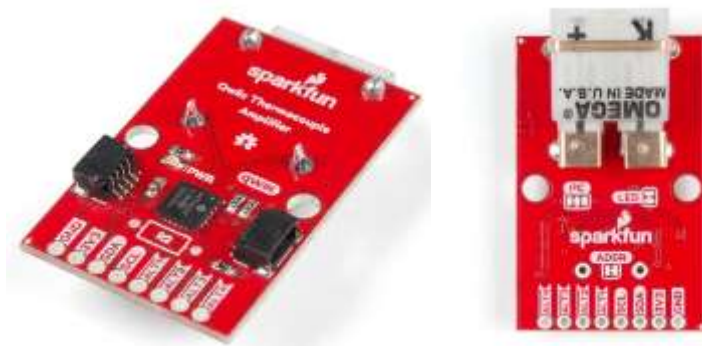
Figura 4 Componente amplificador de la señal del termopar (Thermocouple Amplifier)
