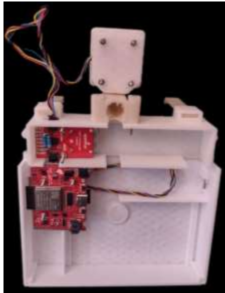
Figura 45 Conexión del Grid-EYE al Amplificador
