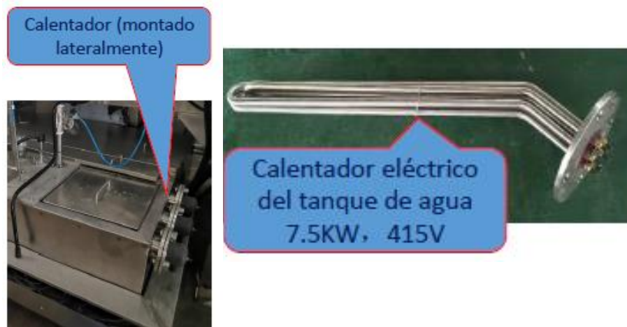
Figura 22. Tanque de almacenamiento con calentador eléctrico.
