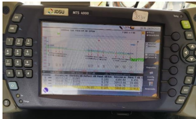
Figura 87.- Ejemplo de Prueba OTDR. Obtenido de: García Sedas A. J., (2021). Reinstalación de cable de guarda en línea de transmisión de 400kV de Pachamama II
