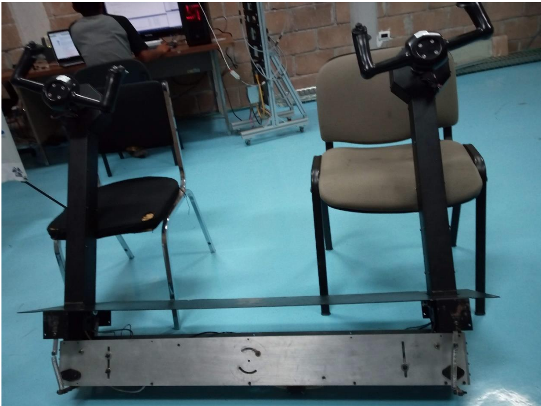
Ilustración GGGG Fotografía de Columnas de C-295.
