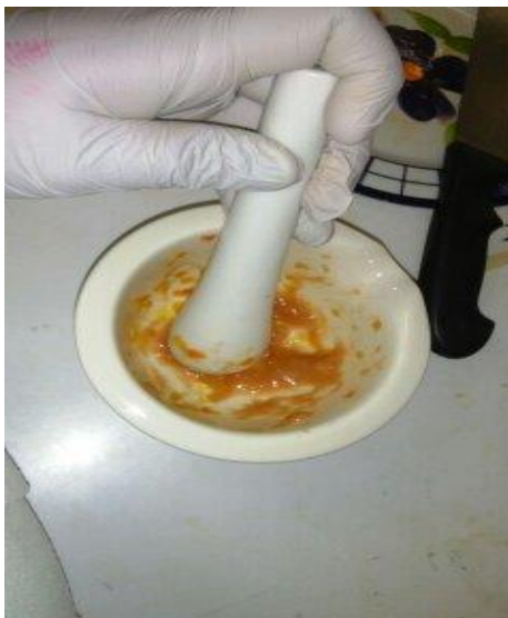
Figura 10. Pulpa obtenida mediante un mortero de porcelana de 30 ml y un pistilo de 10 cm.
