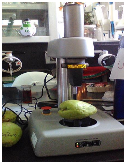
Figura 8. Texturómetro utilizado para medir la resistencia a la penetración de los frutos de chayote.
