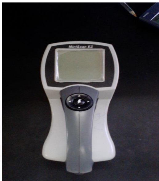
Figura 6 Colorímetro usado para realizar el análisis. Fuente: Elaboración propia.
