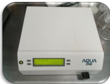
Figura 15 Higrómetro marca AquaLab.
