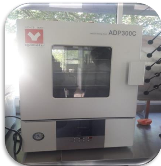
Figura 17 Estufa de vacío marca Yamato modelo Vacuum Drying Oven ADP300C.
