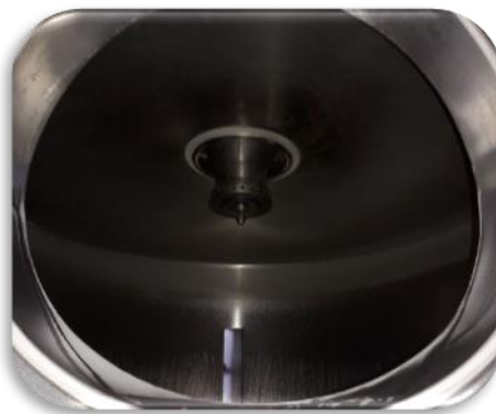
Figura 4 Atomizador rotativo (Marca Niro).
