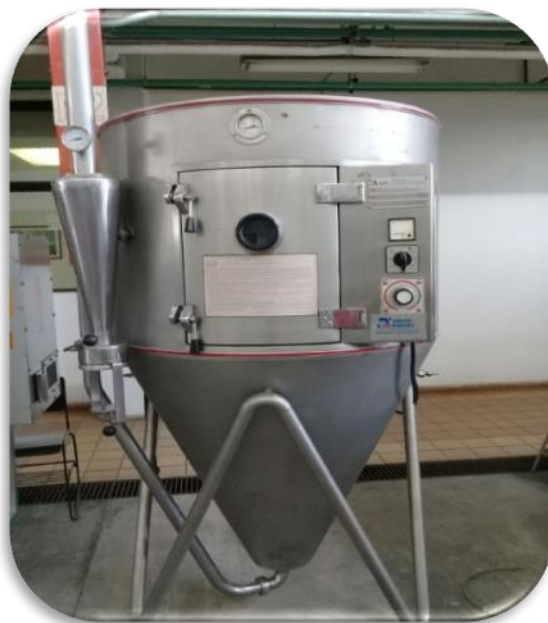
Figura 14 Secador APV por atomización marca anhydro.
