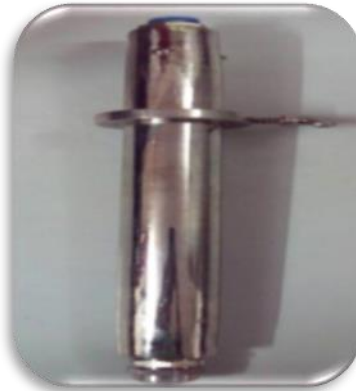
Figura 5 Boquilla de presión (o hidráulica). (Anandharamakrishnan & Padma Ishwarya, 2015)
