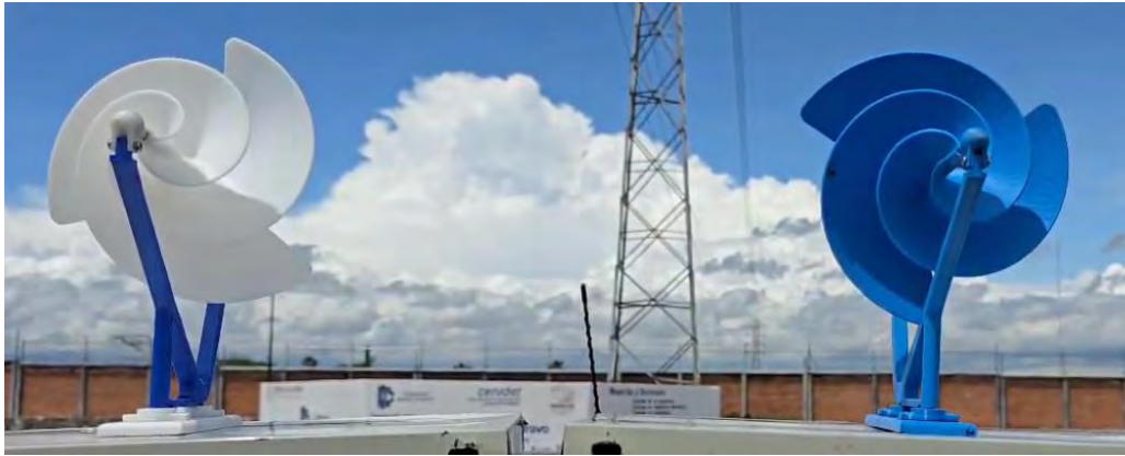
Figura 9.5 Pruebas experimentales de ambos diseños de rotor del aerogenerador ASWT.
