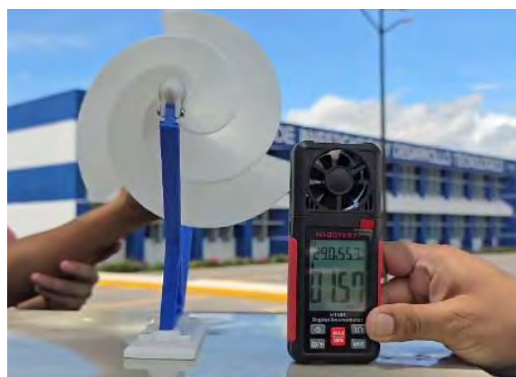
Figura 9.7 . Prueba del rotor propuesto y medición de la velocidad del viento.
