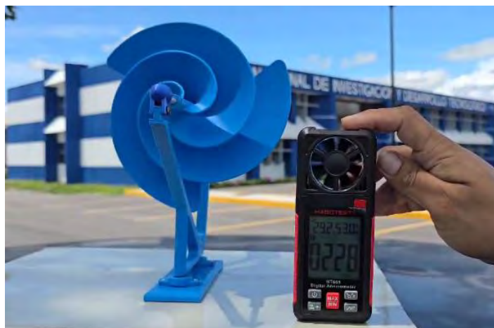
Figura 9.6 . Prueba del rotor de referencia y medición de la velocidad del viento.
