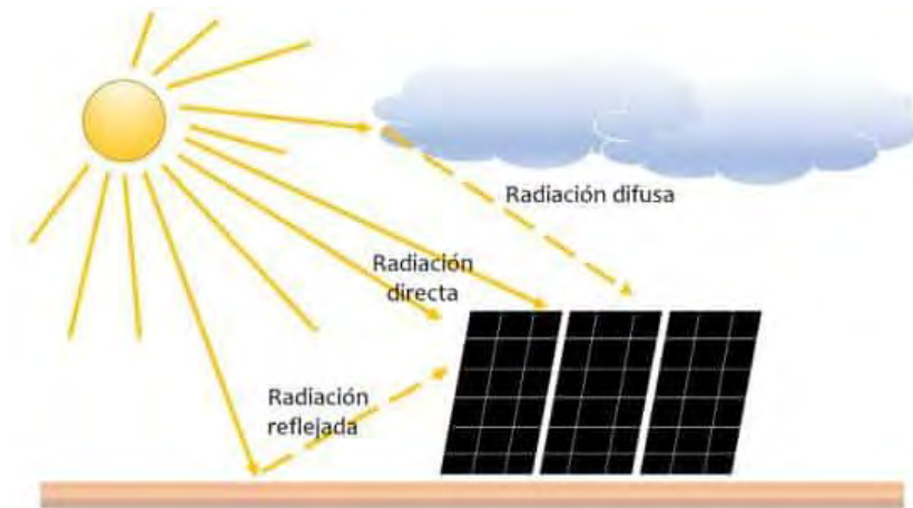
Figura 2.1 Componentes de la radiación global (Bulnes y Brown, 2015).
