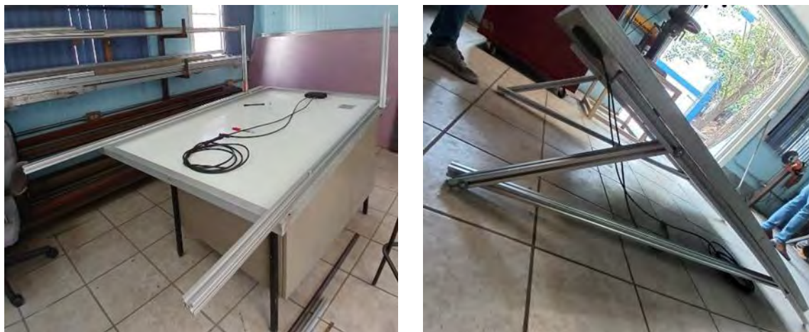
Figura 3.10 Construcción y ensamblaje de la estructura del panel fotovoltaico.
