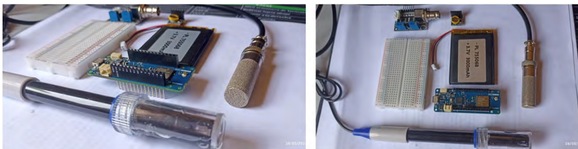
Figura 7. Componentes seleccionados para la construcción del nodo sensor subterráneo, considerando criterios técnicos. Fuente: Elaboración propia.
