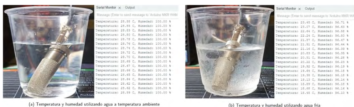
Figura 11. (a) Lectura de temperatura y humedad en agua a temperatura ambiente. (b) Lectura con agua fría para observar variación térmica y de humedad. Fuente: Elaboración propia.
