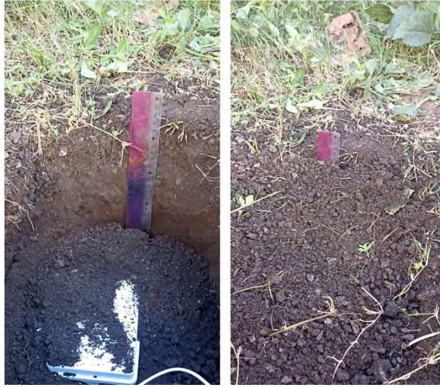
Figura 18. Proceso de instalación del nodo sensor subterráneo embebido con el algoritmo de limpieza de datos en flujo para realizar las pruebas de integración. Fuente: Elaboración propia.
