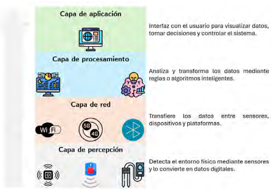
Figura 2. Arquitectura en capas jerárquicas ascendentes en un sistema del Internet de las Cosas. Fuente: Elaboración propia.
