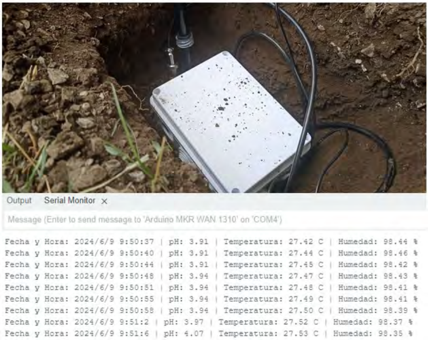
Figura 13. Registro de marca de tiempo y valores de sensores (pH, temperatura y humedad) capturados en una lectura conjunta. Fuente: Elaboración propia.
