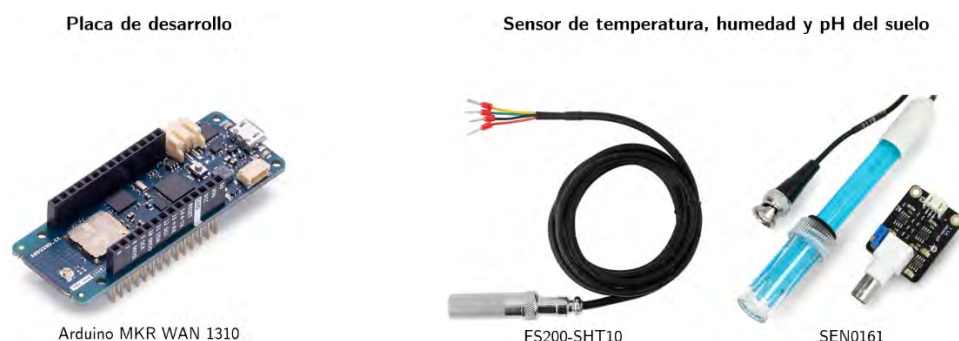
Figura 6. Sensores y placa de desarrollo seleccionados para el nodo sensor del Internet de las Cosas Subterráneas tras la evaluación multicriterio. Fuente: Elaboración propia.
