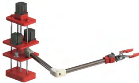
Figura 4.1: Primer diseño del brazo robótico de 5 GDL.
