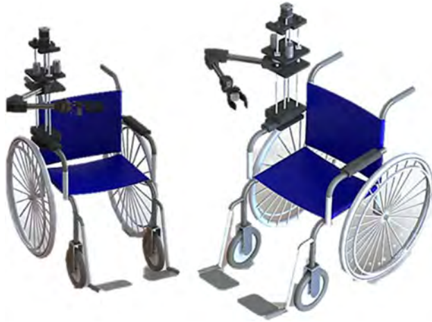
Figura 4.8: Manipulador montado en el reposabrazos de la silla de ruedas.
