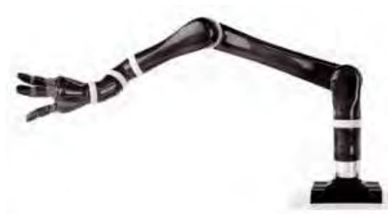
Figura 2.6: Brazo robótico de asistencia JACO (IEEE Spectrum, 2018).
