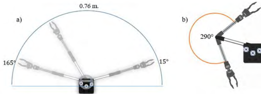
Figura 5.21: a) Rango de movimiento del brazo, b) Rango de movimiento del antebrazo.
