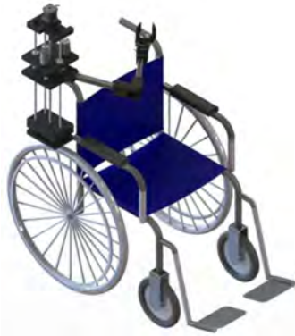
Figura 4.9: Imagen representativa del manipulador en la parte posterior de la silla de ruedas.
