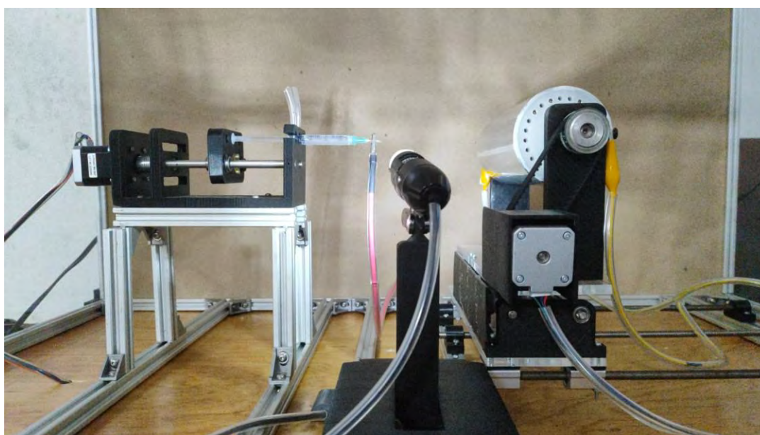
Figura 4.2 Montaje del sistema de electrohilado utilizado en las pruebas experimentales.
