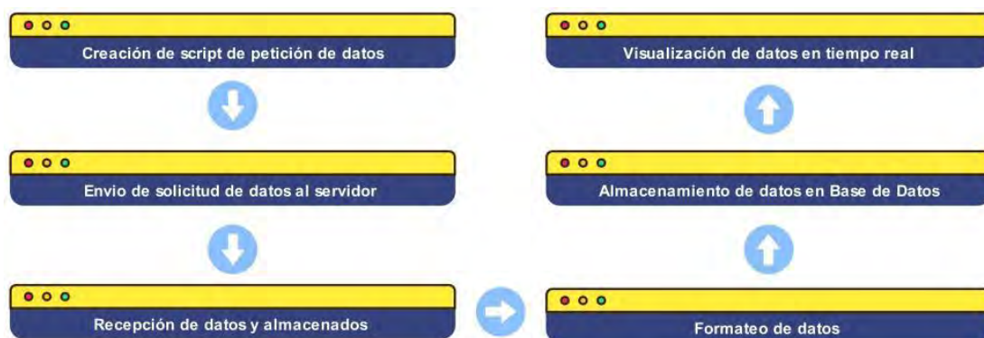
Figura 4.13. Diagrama del flujo de procesos para el diseño de sistemas de almacenamiento en tiempo real
