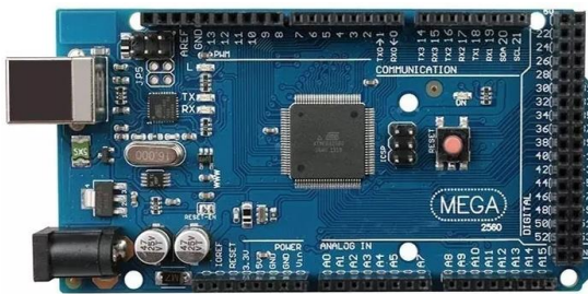
Imagen 45. Montaje probador de circuitos. a) Arduino Mega 2560, b) Placa PCB-ZIF montada en Arduino Mega 2560.
