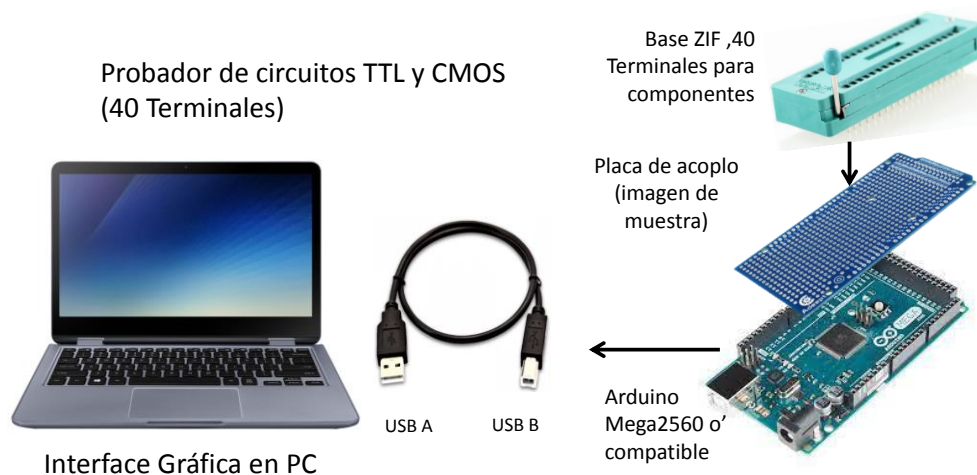
Imagen 4. Probador de circuitos TTL y CMOS propuesto (40Terminales).
