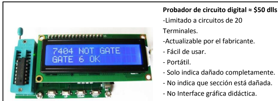
Imagen 1. Probador circuitos TTL Económico.
