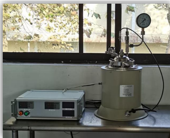
Figura 2.4 Reactor para CHT
