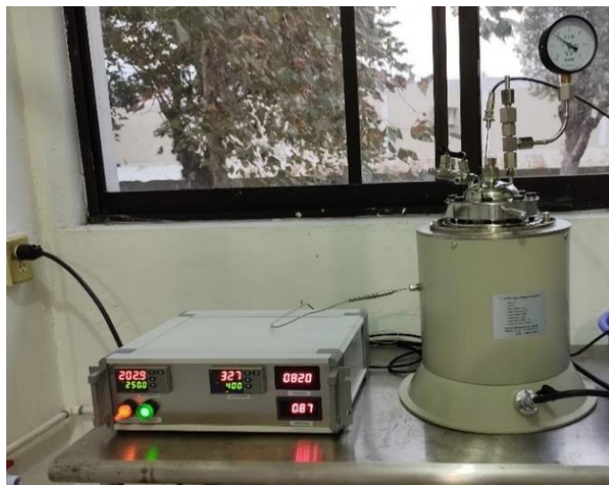
Figura 2.6 Reactor automatizado de calentamiento propio
