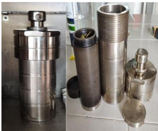
Figura 2.5 Reactor automatizado de calentamiento propio
