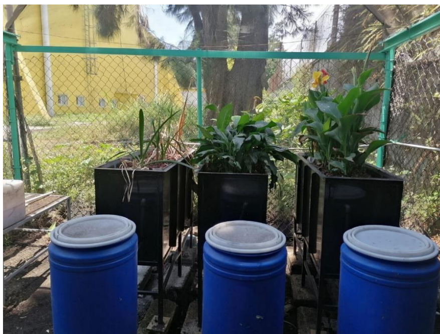
Figura 3.1 Humedal construido (RBA-HC)
