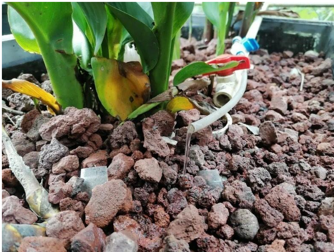
Figura 3.3 Alimentación de efluente al humedal construido (HC).
