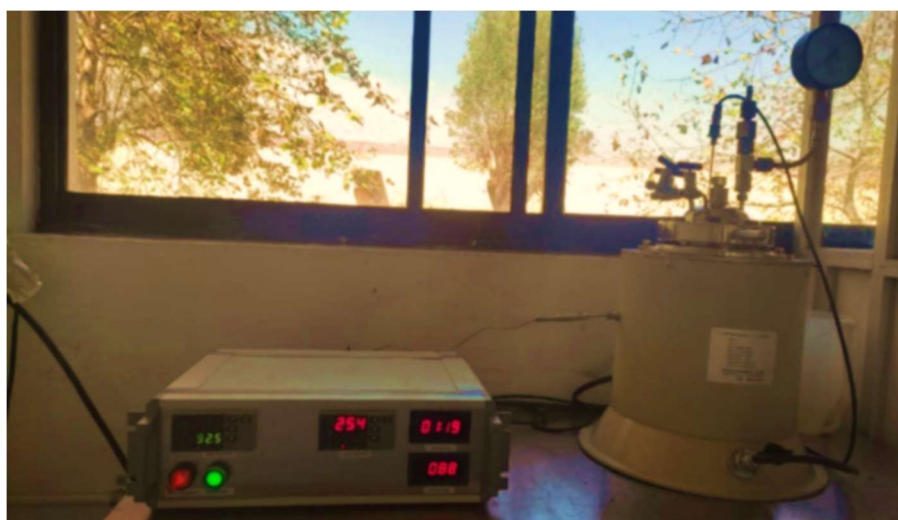
Figura 2.4 Reactor para HTC.
