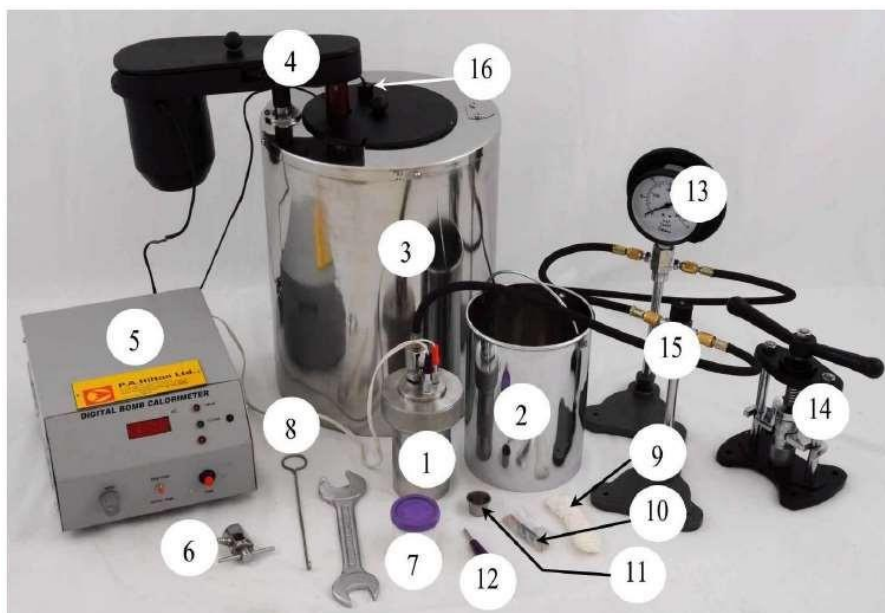
Figura 2. 3 Elementos de la bomba calorimétrica, marca P.A. Hilton LTD, modelo C200 (Murillo-Hernández, 2019)
