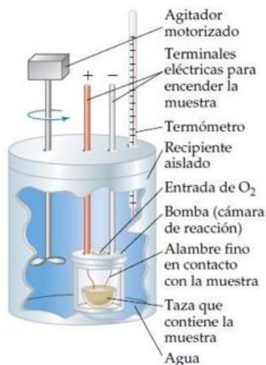
Figura 2. 2 Bomba calorimétrica y sus componentes (Murillo-Hernández, 2019)
