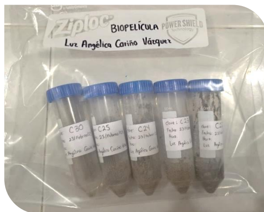
Figura 2.5 Muestras de biopelícula recolectadas al término de una etapa operativa
