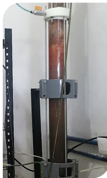
Figura 3.2 Lecho fluidizado inverso del RAH
