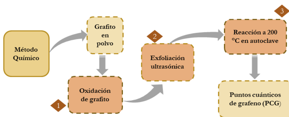
Figura 2.4. Proceso para la obtención de puntos cuánticos de grafeno.
