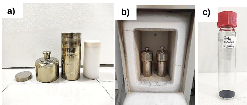
Figura 2.7. a) Autoclave de acero inoxidable. b) Mufla de marca Barnstead/Thermolyne. c) Puntos cuánticos de grafeno.
