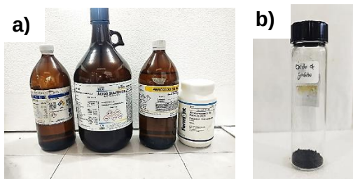
Figura 2.6. a) Reactivos químicos utilizados en la oxidación del grafito. b) Óxido de grafito obtenido.
