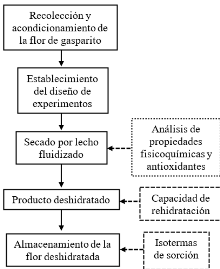
Figura 2.1 Metodología general para el proceso de secado por lecho fluidizado de la flor de Gasparito.
