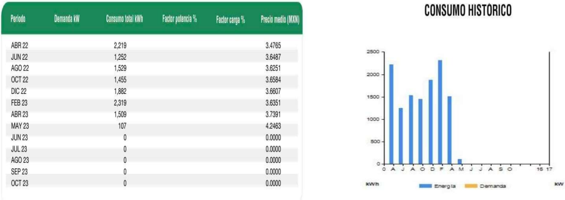
Imagen 24. Graficas del consumo posterior de la instalación del sistema fotovoltaico.
