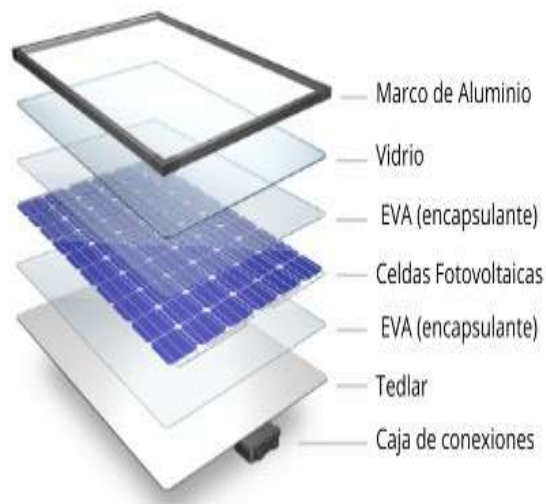
Imagen 5: partes de un módulo fotovoltaico [41].
