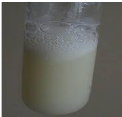
Figura 33. Identificación de azufre
