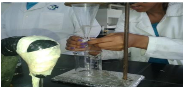
Figura 9. Decantación de la fase inferior
