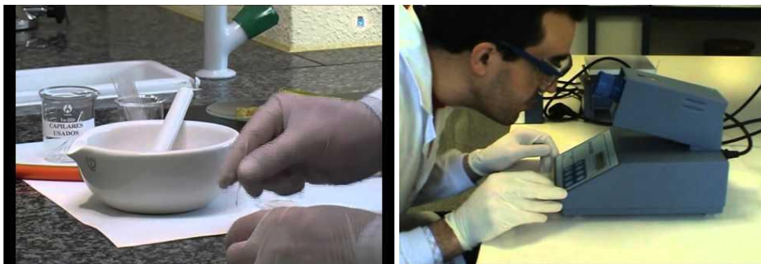
Figura 16. Determinación del Punto de fusión del Naftaleno
