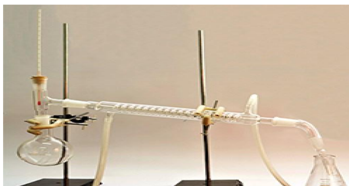
Figura 72. Purificación del Amileno
