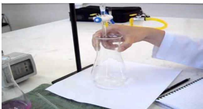
Figura 25. Determinación de la acidez del limón
