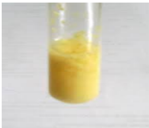
Figura 34. Identificación de Halógenos
