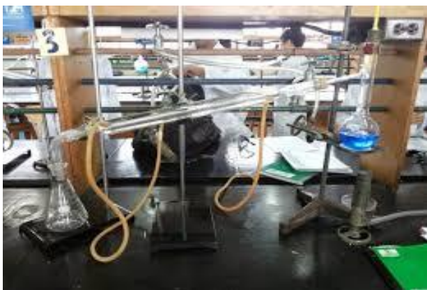
Figura 70. Obtención de Amileno
