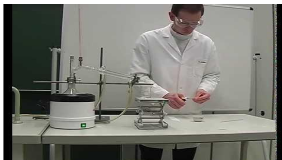
Figura 83. Destilación del Nitrobenceno
