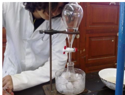
Figura 80. Adición de Ac. sulfúrico
