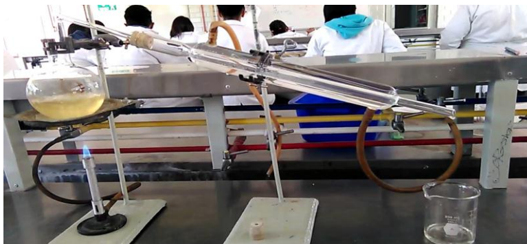
Figura 73. Obtención de 2-Penteno
