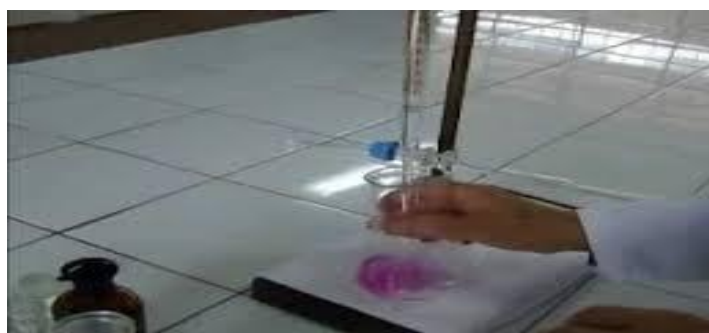
Figura 23. Determinación de la acidez de un vinagre
