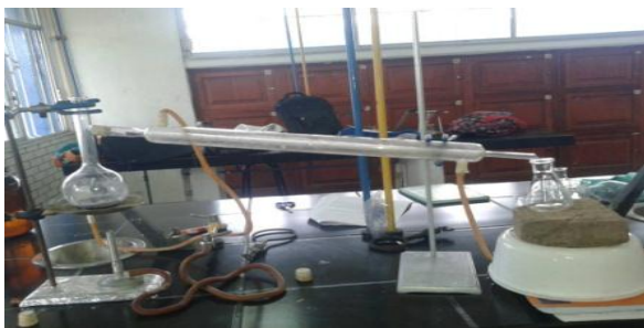
Figura 6. Obtención de acetato de n-amilo
