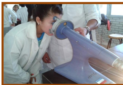
Figura 18. Lectura en polarímetro
