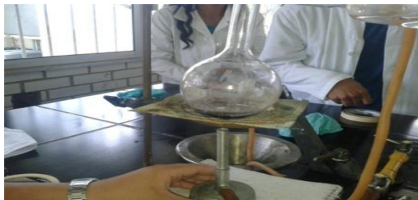
Figura 7. Destilación de acetato de n-amilo
