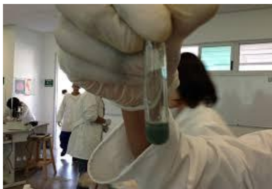
Figura 32. Identificación de Nitrógeno
