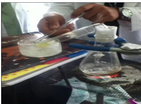
Figura 52. Tubo de desprendimiento
