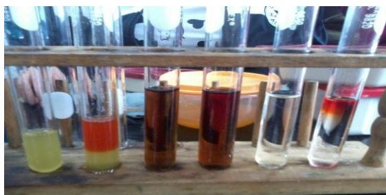
Figura 29. Medida del pH con Indicadores Naturales
