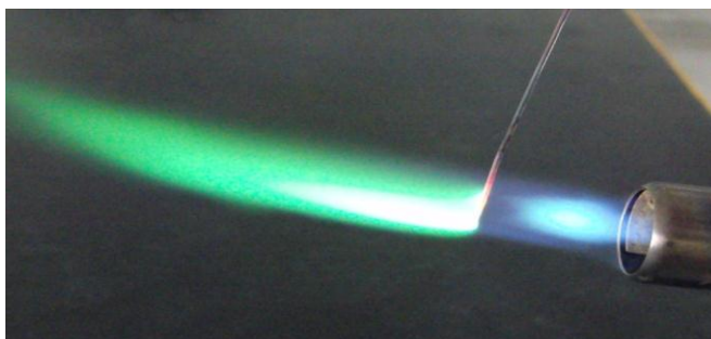
Figura 69. Prueba de Beilstein (flama color verde)
