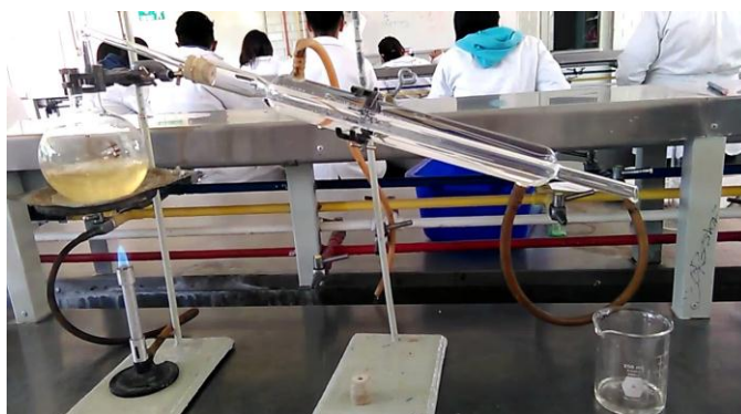
Figura 68. Obtención de Bromuro de Etilo
