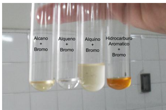
Figura 78. Prueba de adición de Bromo
