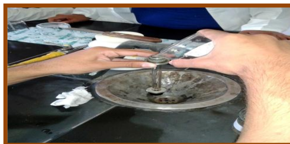
Figura 20. Llenado de celda polarimétrica
