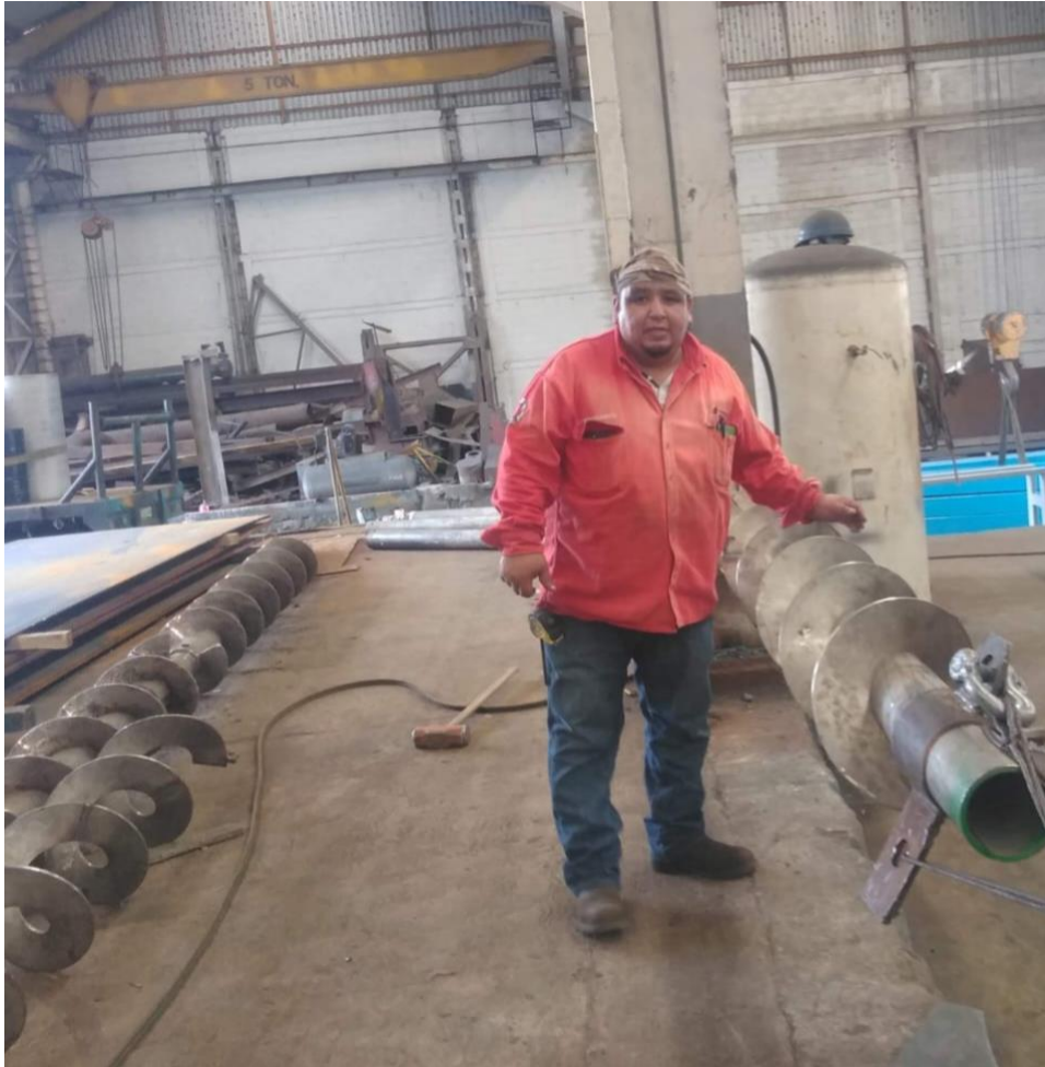
Imagen 3.24. Se aprecian todas las secciones que forman parte del conductor.
