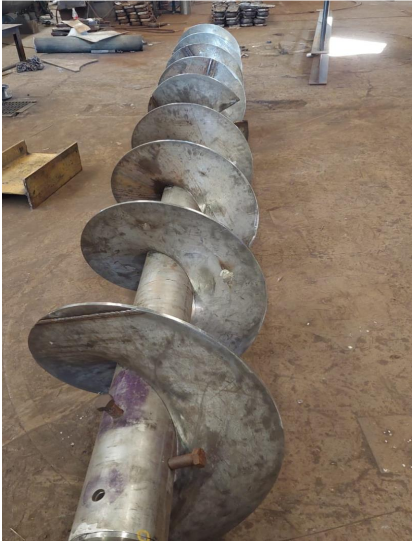
Imagen 3.21. Sección secundaria terminada previo al proceso de soldadura. Se aprecia la hélice montada sobre su eje final.
