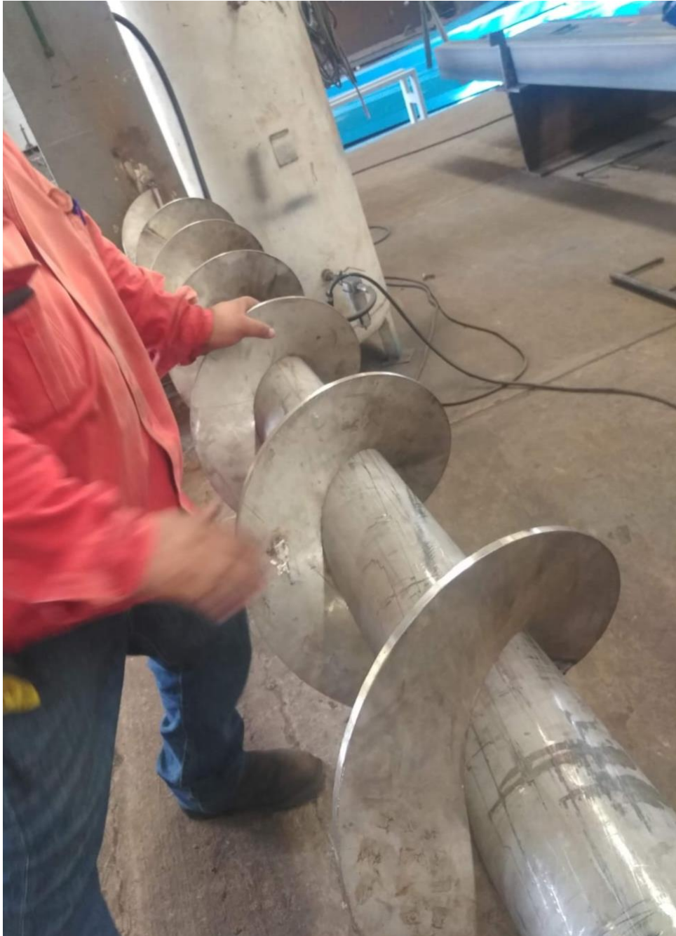
Imagen 3.23. Verificación del paso y longitud del listón sobre su eje final.
