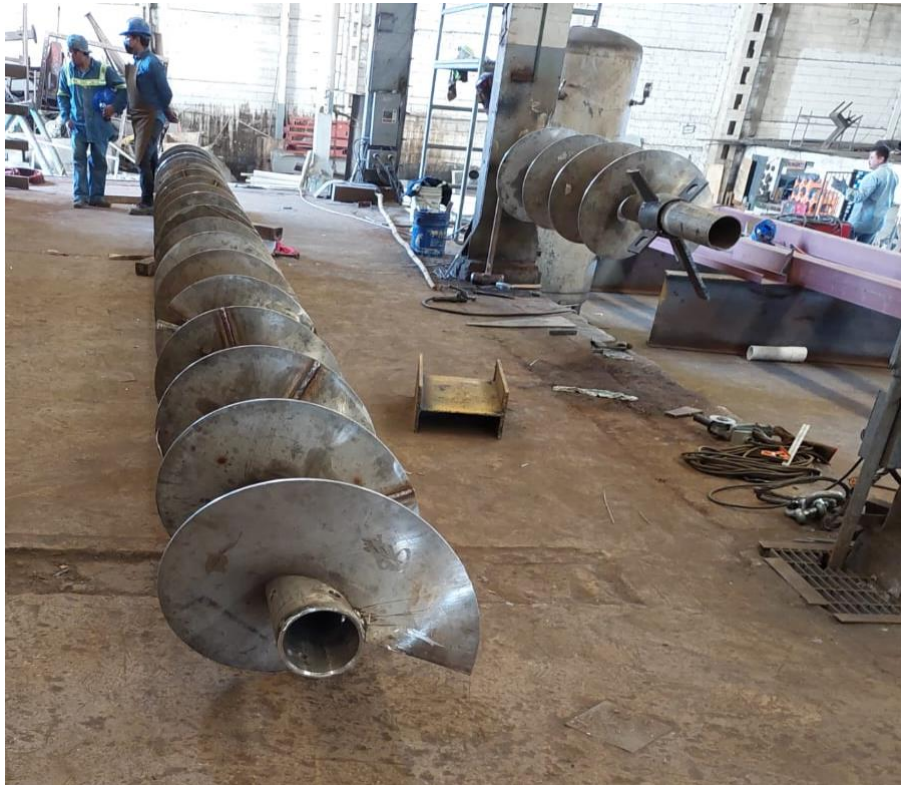
Imagen 3.22.Unión de secciones del conductor para corroborar la correcta secuencia del listón y determinar la correcta dirección de giro.
