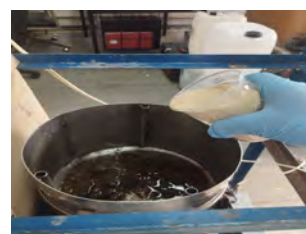
Figura 5.31: La levadura se agrega al reactor.
