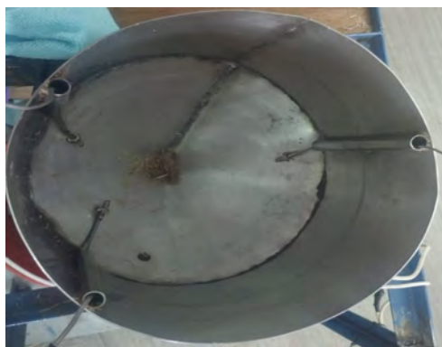
Figura 3.4: Tres tubos soldados dentro del reactor.
