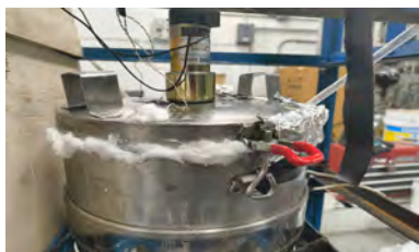
Figura 5.34: El algodón es colocado entre la tapa para tratar de que el reactor sea lo mas hermético posible.
