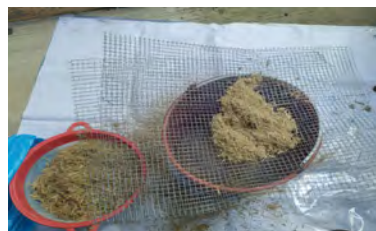
Figura 5.2: El bagazo es cernido con ayuda de la malla de 1 cm.
