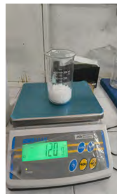
Figura 5.14: El hidróxido es pesado en una bascula.
