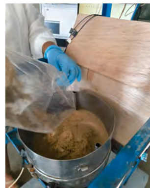
Figura 5.9: Carga del bagazo de caña en el reactor tipo batch.
