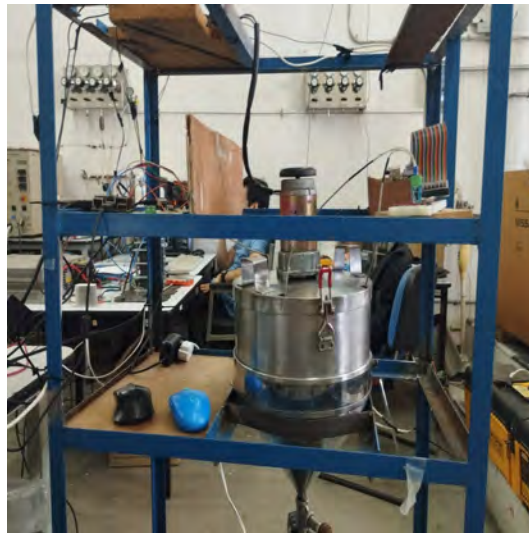
Figura 3.15: Planta con los elementos necesarios para realizar los pretratamientos, así como la hidrólisis y fermentación.
