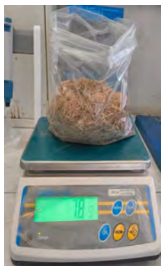
Figura 5.6: Medición de masa del bagazo de caña, clasificado por tamaño de partícula (1 mm a 10 cm), previo al proceso de bioetanol.
