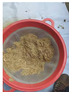
Figura 5.4: Clasificación con colador para trozos grandes.
