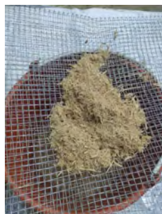
Figura 5.3: Momento donde el bagazo es clasificado.
