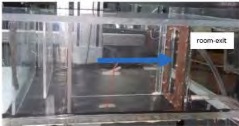
Figura 25. Vista lateral del intercambiador de calor acoplado a la habitación (salida del aire por la ventana del intercambiador)
