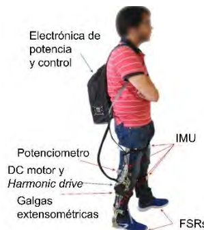
Figura 9. Exoesqueleto robótico/articulación activa en la rodilla y articulación en tobillo [24].
