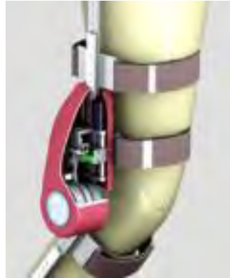
Figura 8. Órtesis activa de rodilla utilizando tecnología ARES [23].
