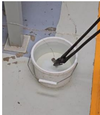
Figura 117: Probeta sumergida en agua a temperatura ambiente para su enfriamiento.
