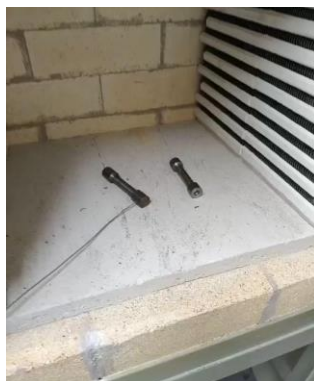
Figura 111: Probeta con el termopar K en el centro de ésta, dentro de la mufla.
