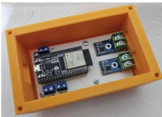
Figura 104: Placa de circuito fijada dentro de la caja impresa en 3D.
