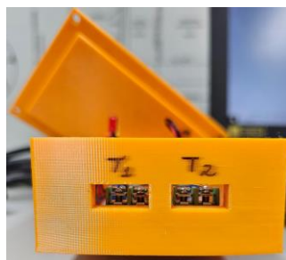
Figura 109: Serigrafiado para la identificación del termopar principal y secundario.
