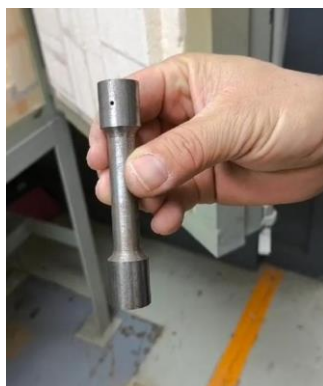
Figura 110: Probeta de hacer AISI 1040 con barreno de 1/16 de pulgada.
