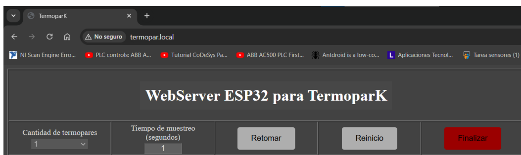
Figura 113: Interfaz gráfica del dispositivo mecatrónico con la configuración elegida.
