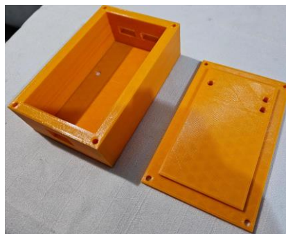
Figura 102: Impresión 3D de la caja para el dispositivo mecatrónico.
