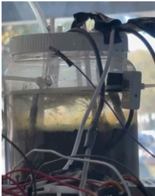
Figura 4.13: Integración del sensor XKC Y26 a la CCMS. Fuente: Elaboración propia.
