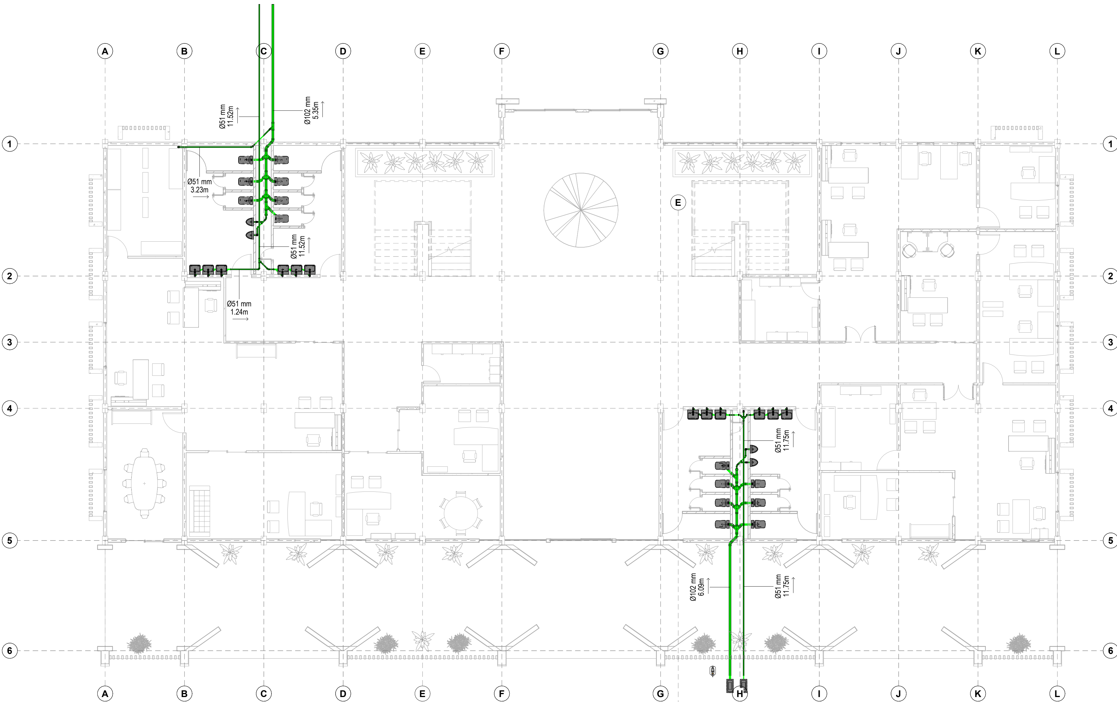
3 INSTALACIÓN SANITARIA- PLANTA BAJA INS-04
