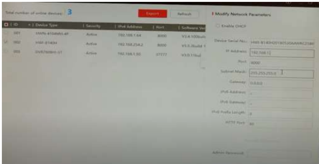
Figura 3.15 Configuración de parámetros de IP en programa SADP (Autoría propia)
