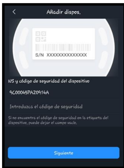
Imagen 77: Ingreso de número de serie a aplicación de CCTV. Fuente: Autoría propia.
