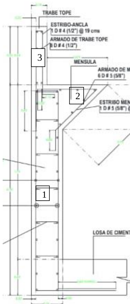
Figura 16- Detalle perfil de muro lateral
