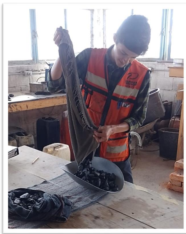
Figura 23 Determinación de gravedad específica y absorción del material grueso “grava” (Autoría propia)
