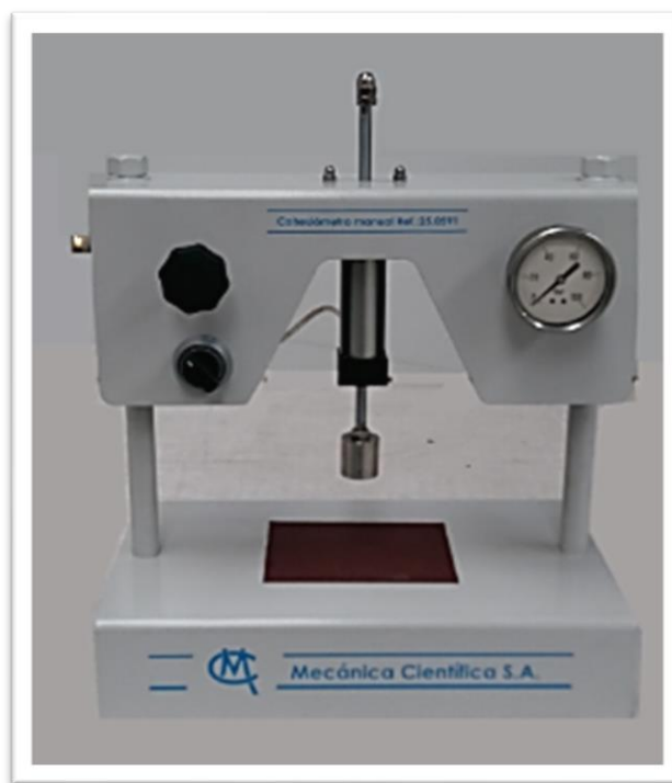
Figura 8 Dispositivo que determina la torsión soportada por la mezcla asfáltica (Científica, 2003)
