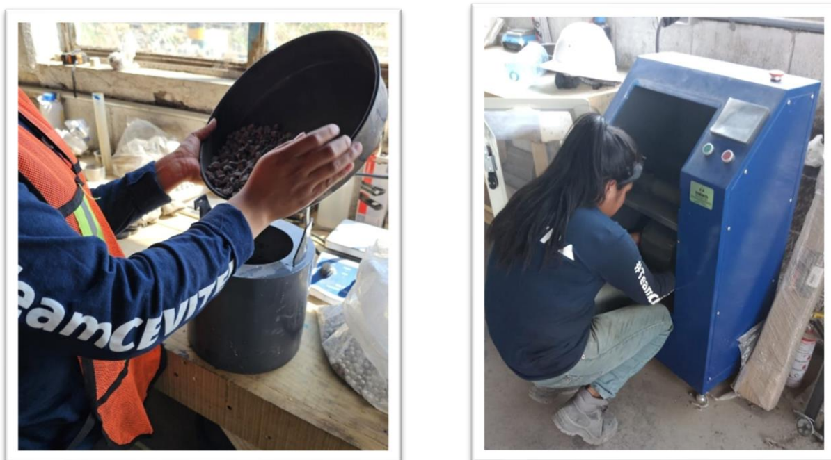
Figura 54 material retenido lavado listo para ingresar a la máquina Micro-Deval, (autoría propia)
