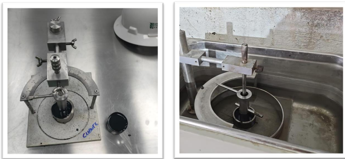
Figura 64 Recuperación elástica por torsión, (autoría propia)
