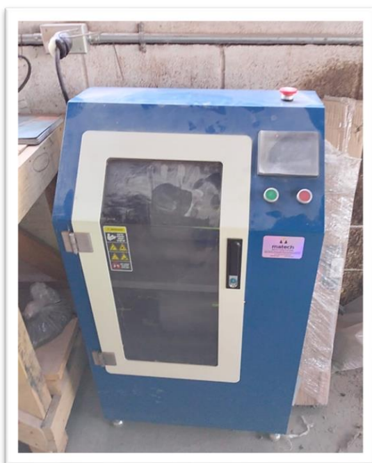
Figura 25 Máquina micro-deval, capaz de determinar la resistencia a la abrasión y durabilidad del agregado pétreo (Autoría propia)
