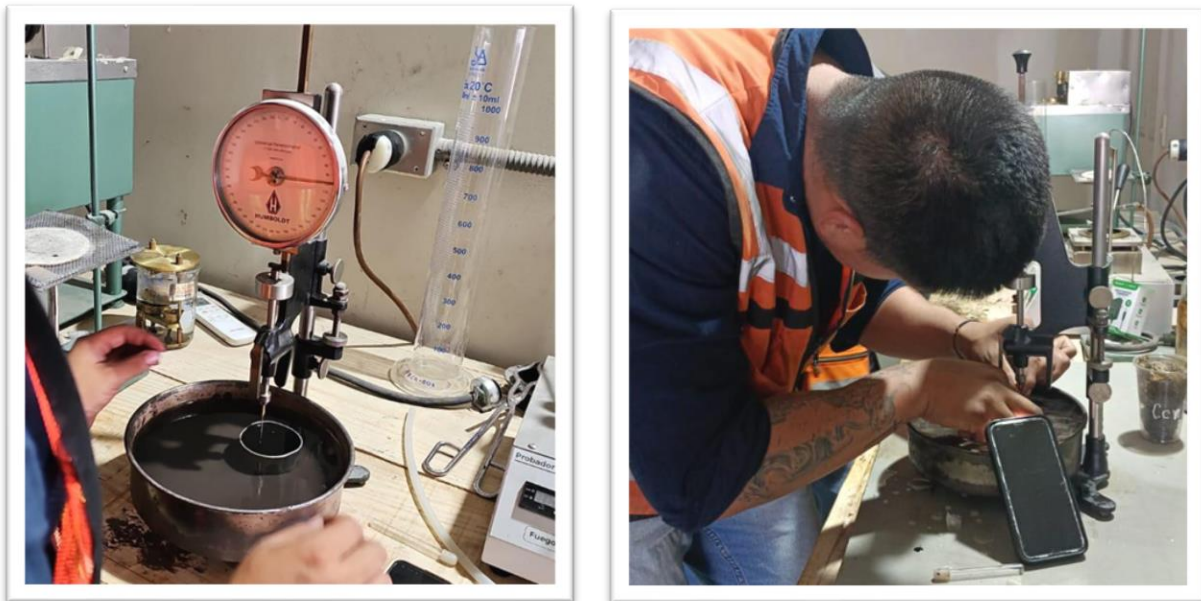
Figura 63 Penetración del asfalto, (autoría propia)
