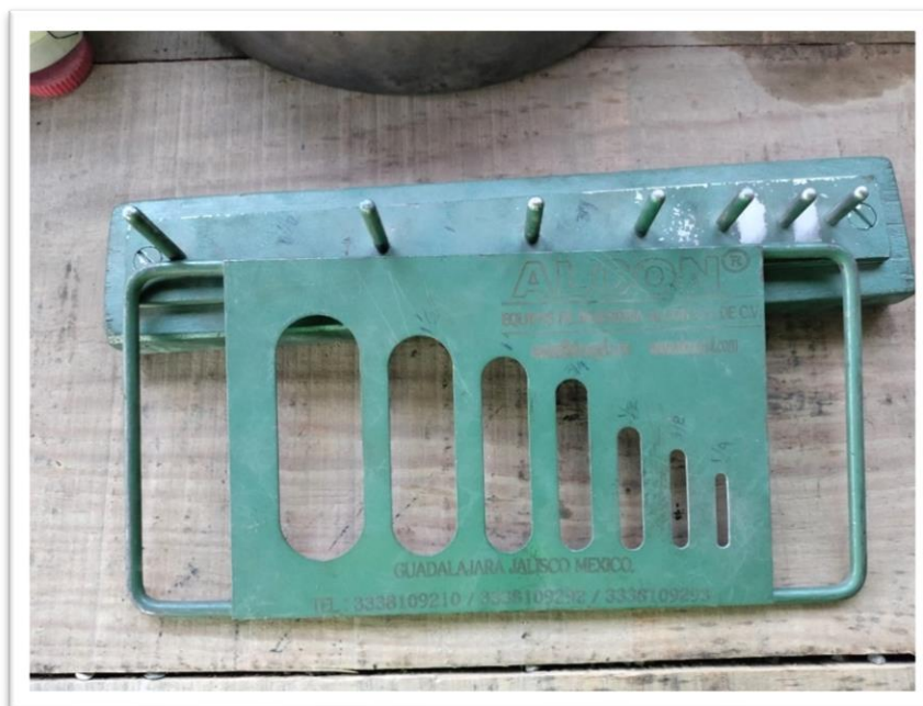
Figura 28 Equipo para determinación de partículas largadas y planas del agregado grueso (Autoría propia)
