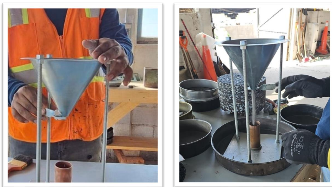
Figura 48 Equipo y vaciado de material en el molde cilíndrico, (autoría propia)
