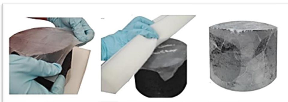
Figura 18 Colocación de Parafilm, para especímenes con absorción mayor a 2.0% (Ayala Y., 2018)
