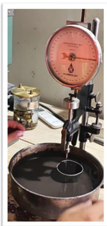
Figura 35 Equipo para penetración de asfalto, penetrómetro (autoría propia)
