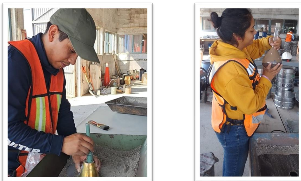
Figura 42 Aforo de picnómetro (a), cono truncado y pisón (b), (autoría propia)
