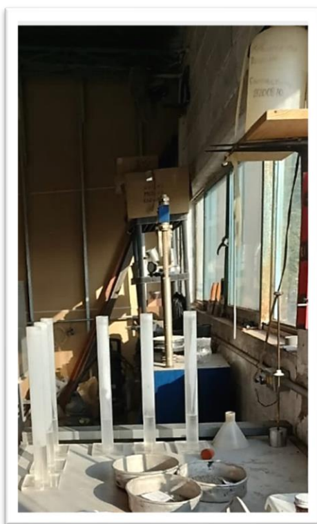
Figura 21 Equipo para determinar equivalente a material fino, probetas, pisón e irrigador (autoría propia)
