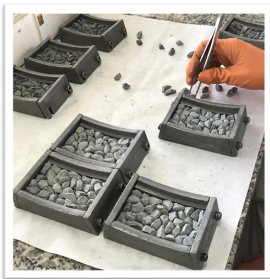
Figura 55 Agregado expuesto a sulfato de sodio, (autoría propia)
