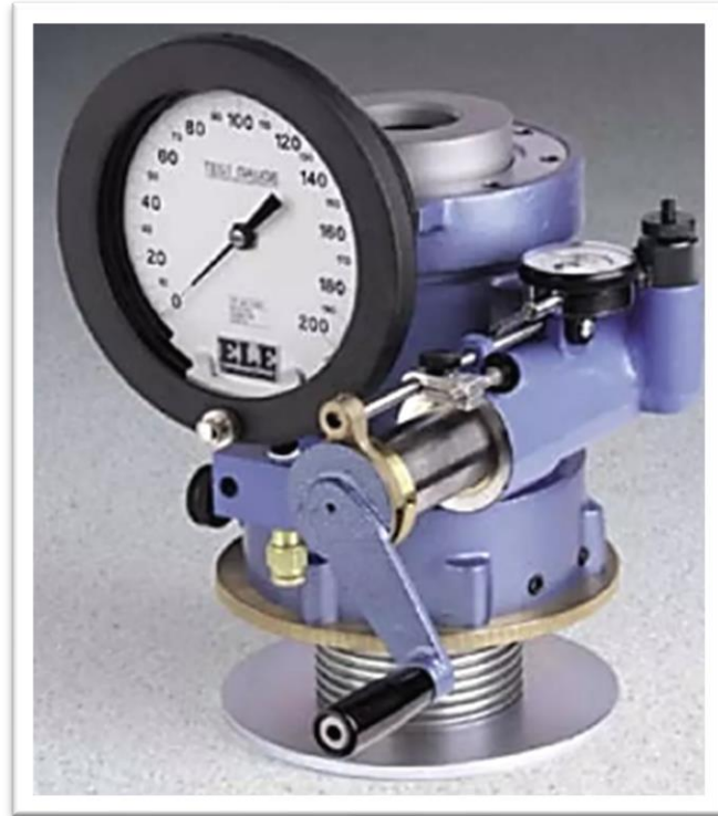
Figura 7 Dispositivo para pruebas triaxiales; determinación de la estabilidad (Sucapuca, 2017)
