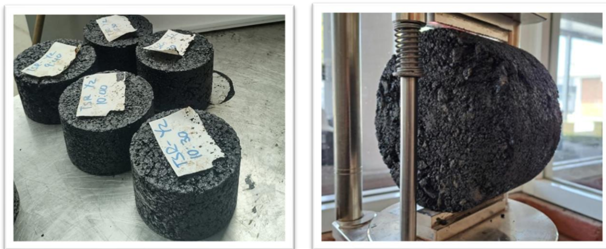
Figura 70 Muestra (a) y ensayo de tensión indirecta a 25°C (b), para determinación de TSR, (autoría propia)
