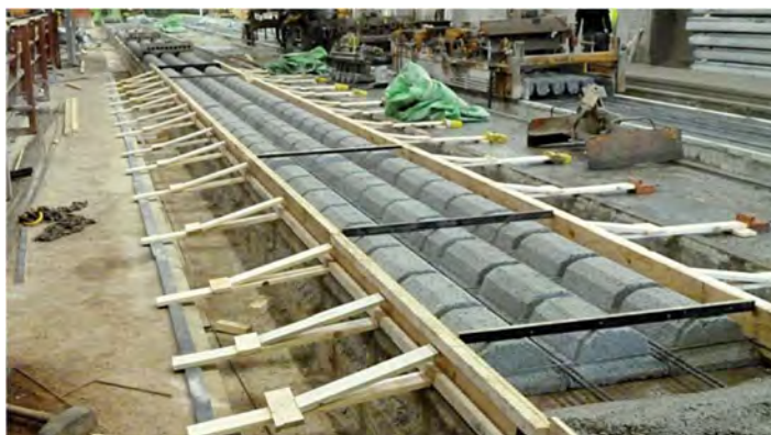
Figura 8. Elaboración de elementos de prueba del prototipo SL-Deck (Hertz et. al., 2014)
