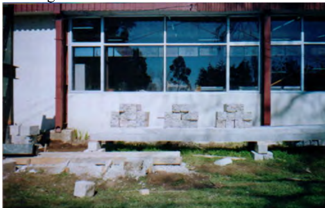
Figura 6. Losa modular con sobrecarga distribuida de 300 kg/m 2 (Teranishi, 2006).
