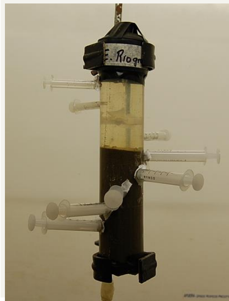
Figura 1.4 Arreglo de la muestra con puertos para análisis más preciso (Salazar y Peñuela, 2010)
