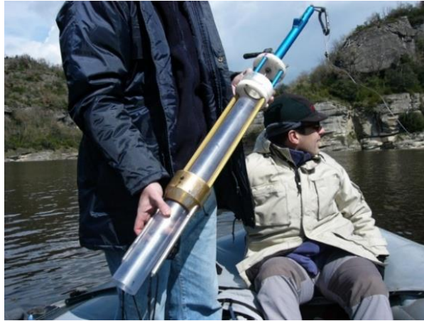
Figura 1.3 Muestreador tipo núcleo (Salazar y Peñuela, 2010)
