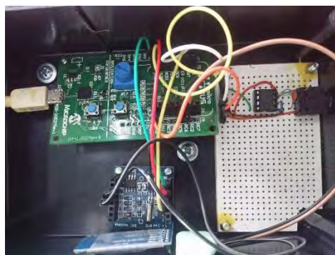
Figura 5. Dispositivo electrónico medidor de energía eléctrica.
