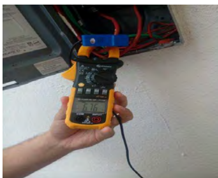
Figura 7.- Comparación de medida con multímetro.
