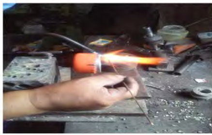
Paso 3. Soldado de pastillas de carburo de tungsteno (WC)
