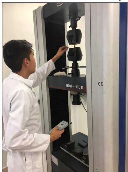
Figura 6. Pruebas de tensión realizadas en la máquina universal
