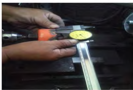
Paso 7. Verificación de medidas
