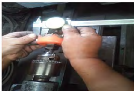
Paso 5. Medición de la pastilla y dimensiones
